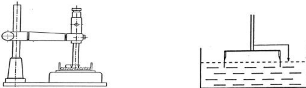
Detalhe do posicionamento da haste sobre a amostra
