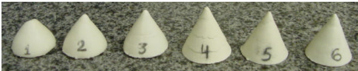
Figura 10: Cones de fusão - análise da fusibilidade - matérias-primas não plásticas:
