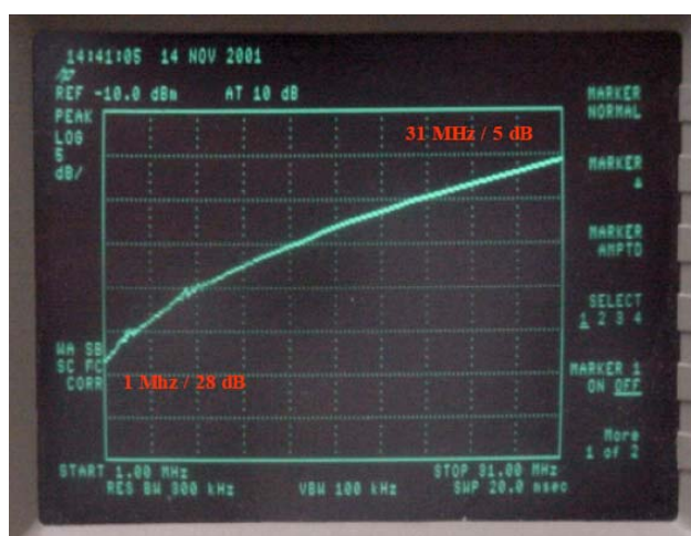
Figura 3.4 - Resposta em frequência de um disjuntor de 100A apresentando característica de filtro passa-altas
