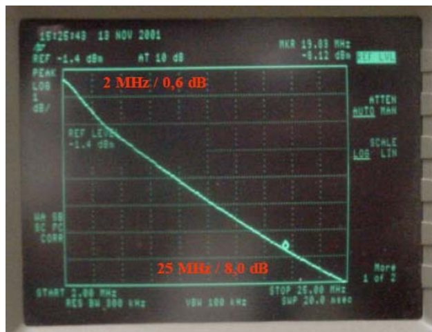
Figura 3.3 - Resposta em frequência de um disjuntor de 100A apresentando característica de filtro passa-baixas
