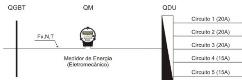
Figura 5.6 – Diagrama elétrico unifilar de uma unidade consumidora (cenário residencial)
