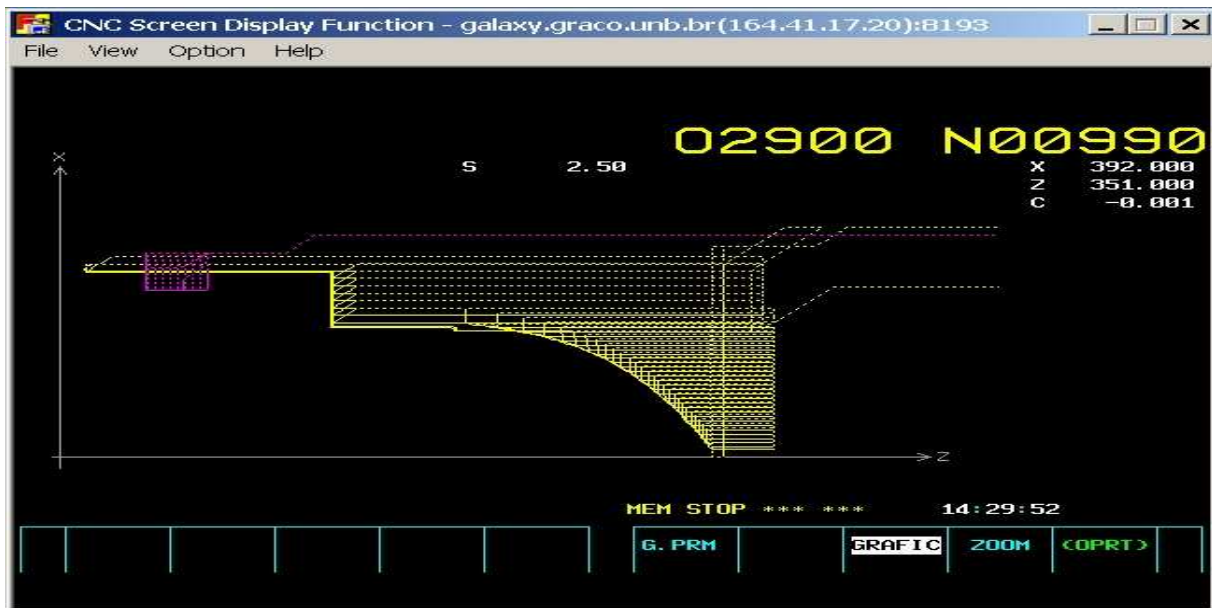
Figura 12.35: Simulação do programa NC no CNC do Galaxy 15M para a peça espelho hiperbólico modelada por spline .
