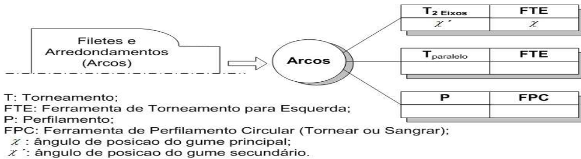
Figura 7.16: Grafo E/OU apresentando alternativas de usinagem para feature do tipo filete ou arredondamento.
