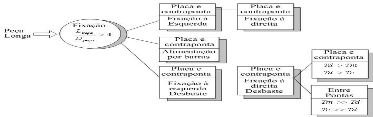
Figura 7.1: Grafo e/ou setup : alternativas para setup da peça quando \frac{L_{peca}}{D_{peca}} > 4 .
