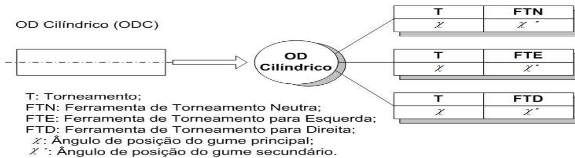
Figura 7.7: Grafo E/OU apresentando alternativas de usinagem para feature do tipo OD (Diâmetro Externo) cilíndrica/retilínea.
