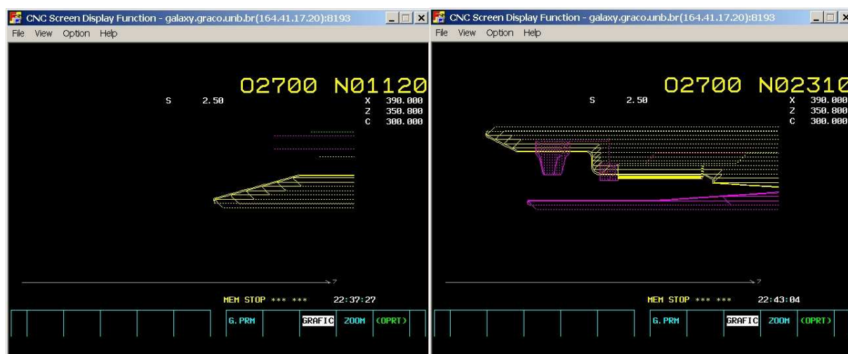
Figura 12.25: Simulação dos programas NC no CNC do Galaxy 15M para a peça romi no Setup1 e Setup2 .
