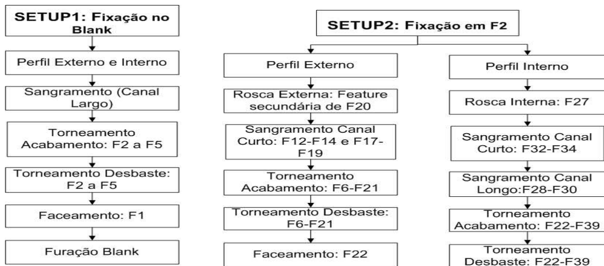
Figura 8.3: Roteamento para o Setup1 e Setup2 da peça exemplo, relacionando as features de projeto (F1 - F39), sendo representado na ordem inversa.
