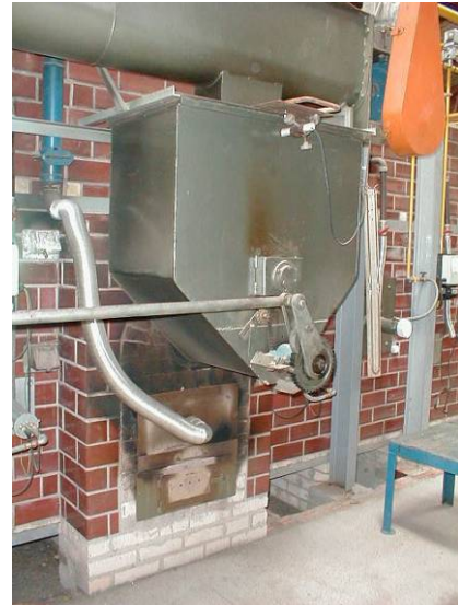
Figura 3.6: Caixa de alimentação de serragem, com acionamento por catraca; parte inferior, a grelha onde é injetado o ar de combustão.
