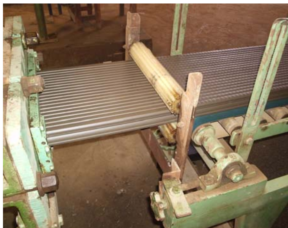
Figura 1.5: Extrusão da massa cerâmica.
