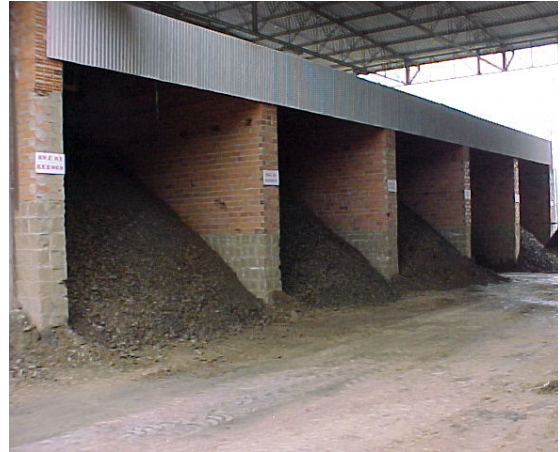
Figura 1.4: Boxes de massa preparada em repouso para homogeneização da umidade.
