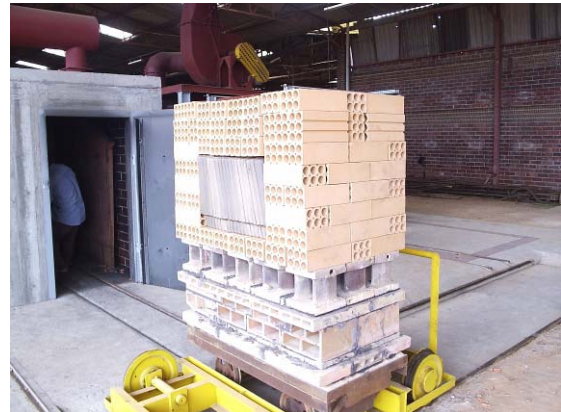
Figura 3.18: Vagoneta com carregamento de tijolos e telhas para teste.
