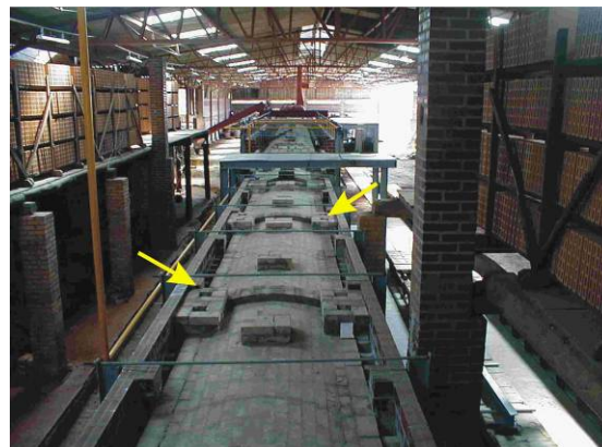
Figura 3.16: Resfriamento indireto finalizado, com saídas para a recuperação de ar quente para o secador.
