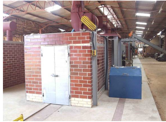
Figura 3.2: Pré-aquecimento pronto, com a chaminé de tiragem, a porta e a bomba do empurrador hidráulico.
