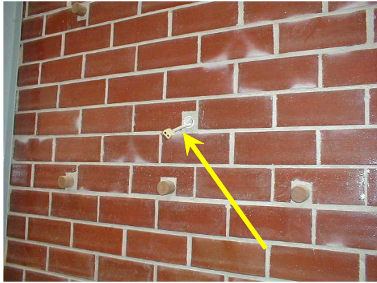
Figura 6.2: Ponto de medição de temperatura no pré-aquecimento, com o termopar posicionado.
