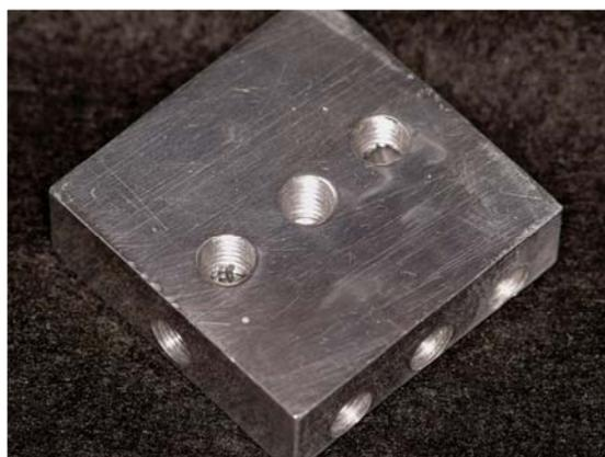
Figura 25 – Vista inferior do dispositivo de localização para corte de dentes utilizado na pesquisa.
