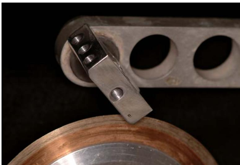
Figura 28 – Demonstração da fixação do dispositivo de localização para corte de dentes com a face superior perpendicular ao disco de corte.
