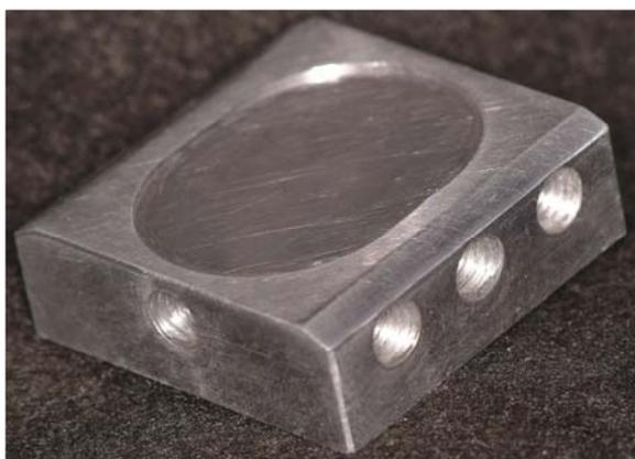
Figura 24 – Vista látero-superior do dispositivo de localização para corte de dentes utilizado na pesquisa.
