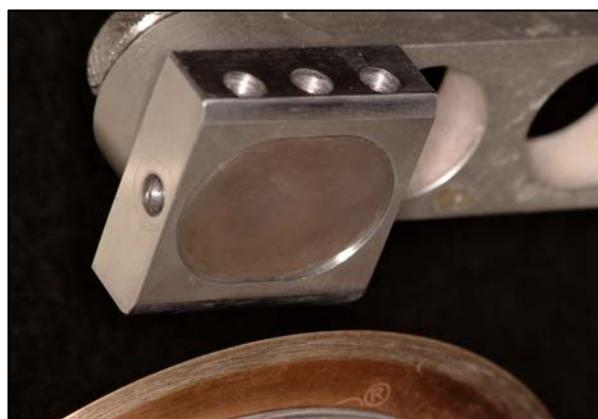
Figura 27 – Demonstração da fixação do dispositivo de localização para corte de dentes paralelamente ao disco de corte.
