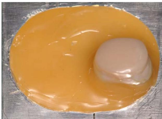
Figura 37 – Fixação com cera pegajosa da coroa dental com a face de corte da raiz voltada para o dispositivo. Note o posicionamento à direita da coroa na área em baixo relevo.
