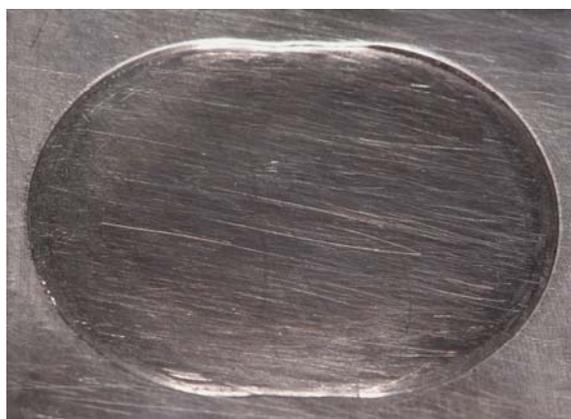
Figura 26 – Vista superior do dispositivo de localização para corte de dentes com detalhe para a área em baixo relevo.
