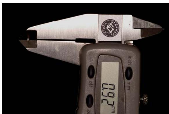
Figura 48 – Mensuração do filete de resina composta e dentina, na região de interface, com paquímetro eletrônico digital (modelo 727, Starrett)
