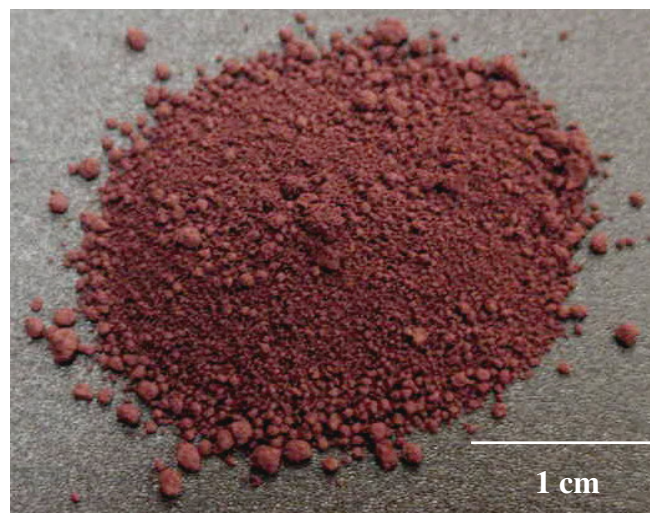
Figura 27 - Fotografia evidenciando o aspecto visual da hematita obtida.
