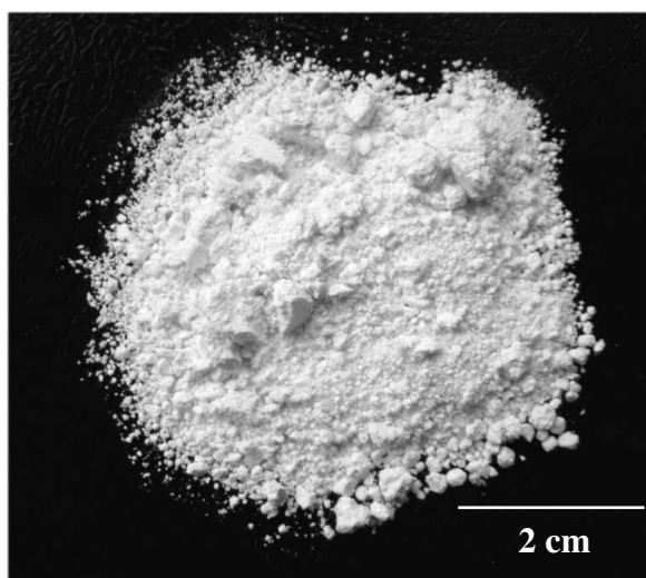
Figura 20 - Fotografia referente à sílica obtida após micronização.
