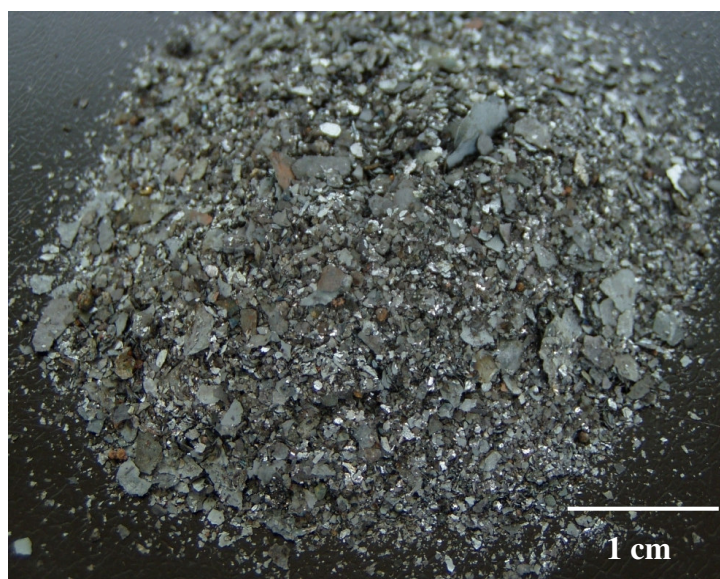
Figura 22 - Fotografia evidenciando o aspecto visual da carepa in natura .
