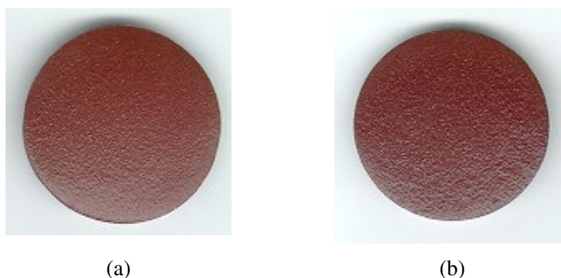
Figura 40 - Fotografias das amostras de grês porcelânico pigmentadas com a hematita sintetizada a partir da carepa de aço: (a) 4% e (b) 8%.
