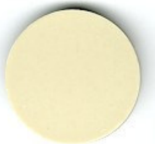
Figura 42 - Fotografia da amostra de grês porcelânico sem adição de pigmento.
