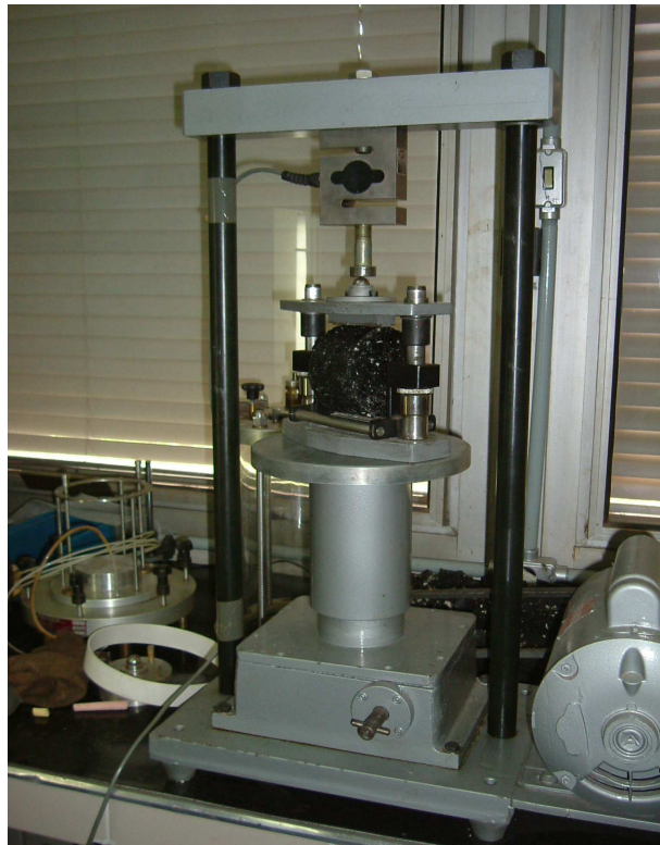
Figura 6.3 - Prensa Marshall utilizada no ensaio de Resistência à Tração Indireta por compressão diametral das misturas asfálticas.
