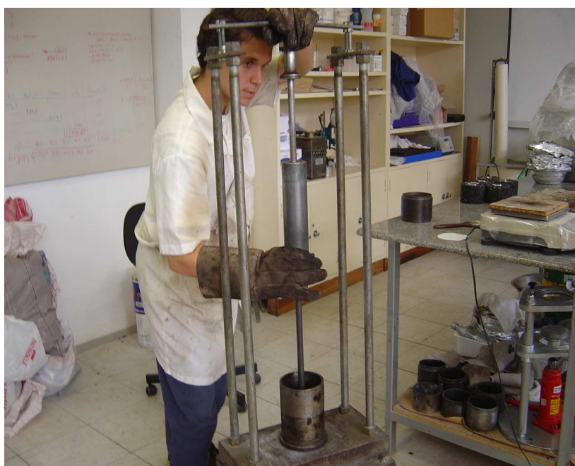
Figura 6.1 - Compactador manual do Ensaio Marshall.
