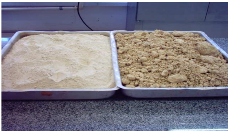
Figura 2.9 - Pó calcário antes (direita) e depois (esquerda) de destorroado.
