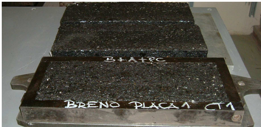
Figura 6.4 - Molde metálico de compactação das placas.
