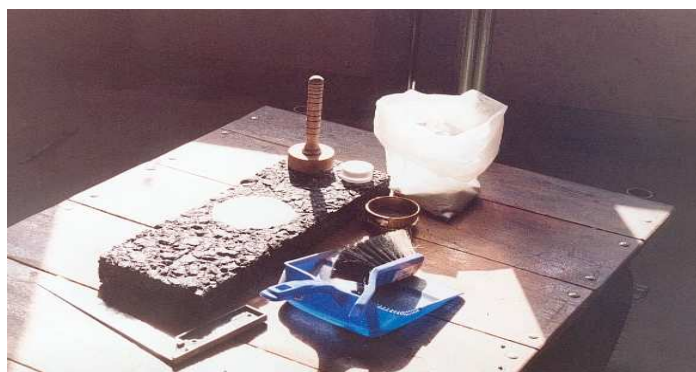
Figura 6.9 - Medição da macrotextura da mistura asfáltica em placas através do ensaio da Mancha de Areia.
