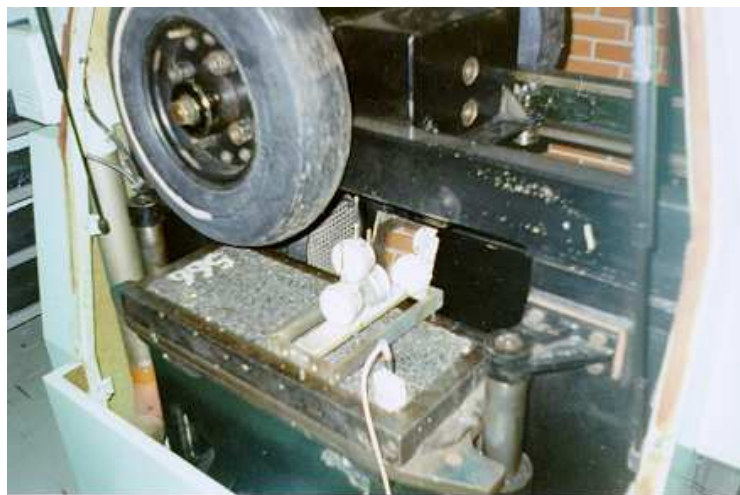
Figura 6.7 - Extensômetros utilizados para leitura das profundidades das deformações.
