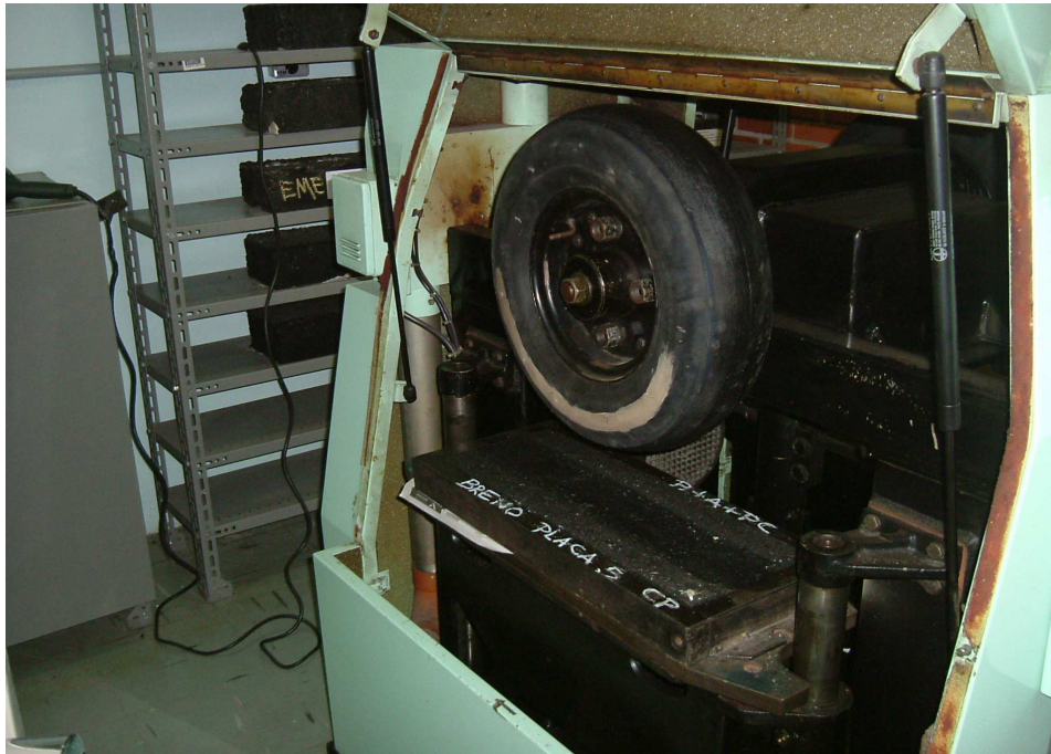
Figura 6.6 - Câmara termo-regulada da máquina de deformação permanente.
