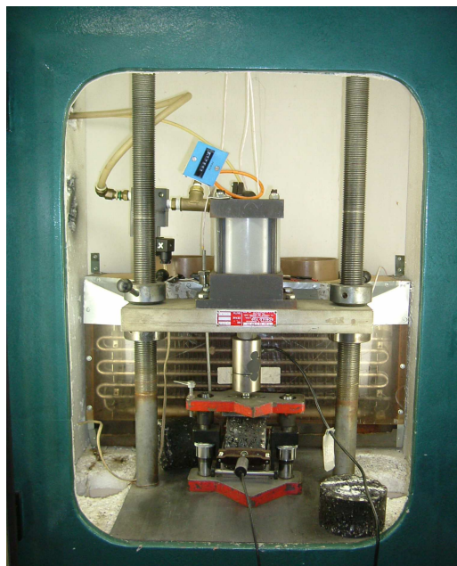
Figura 6.2 - Equipamento para determinação do Módulo Resiliente das misturas asfálticas.
