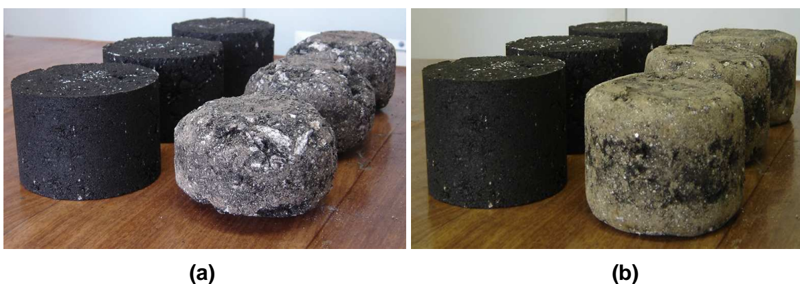
Figura 7.8 - Comparação do desgaste de uma mistura asfáltica antes e depois da execução do ensaio: (a) com 4,5% de CAP e (b) com 6,5% de CAP.
