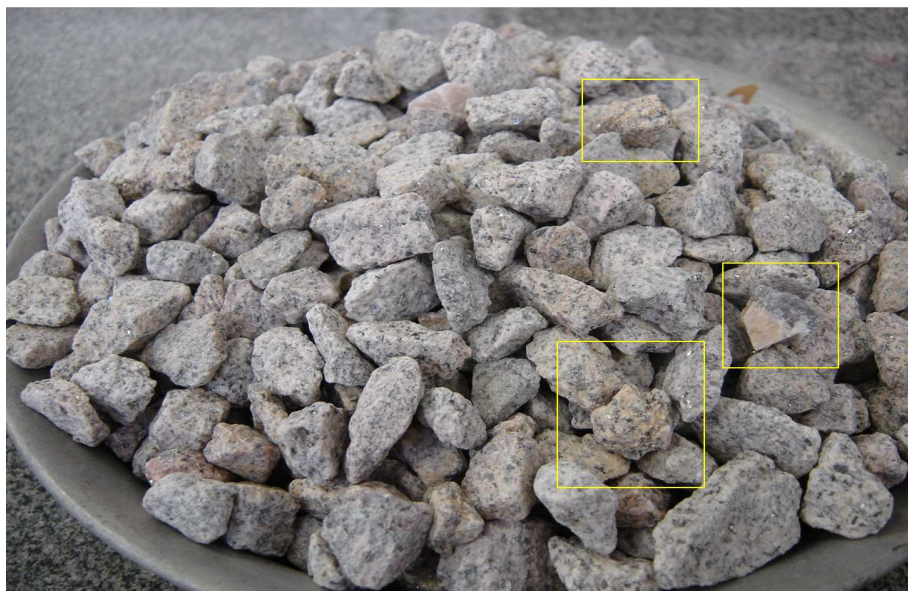
Figura 5.1 - Partículas de rocha granítica com intrusões de solos transportados e minerais nas amostras de brita.
