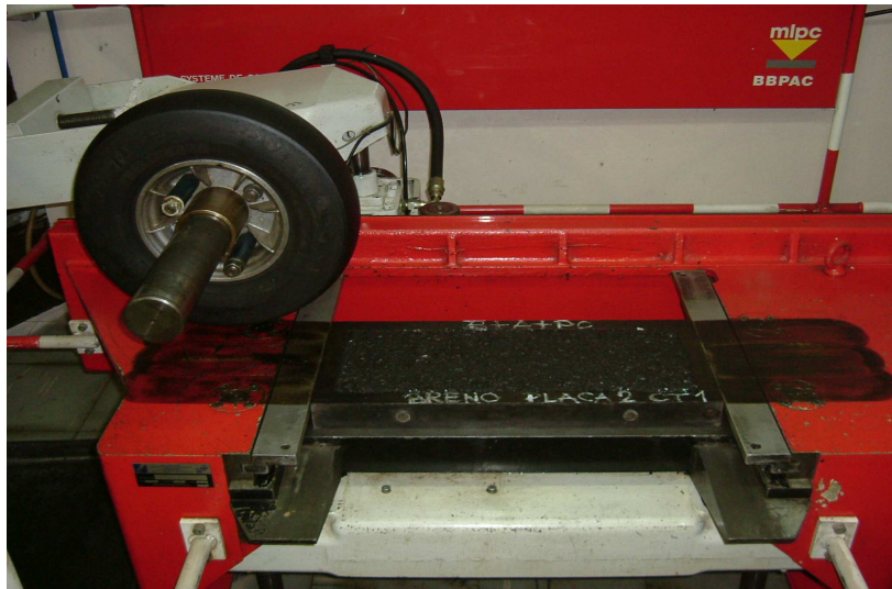
Figura 6.5 - Mesa compactadora das placas das misturas asfálticas.
