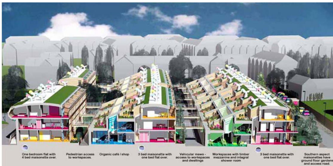
Figura 14. Esquema de funcionamento das unidades 34 .
