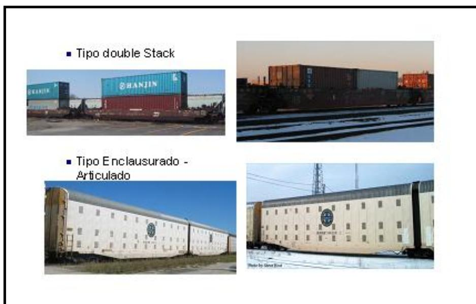
FIGURA 33 - Vagões “double stack” das ferrovias americanas
