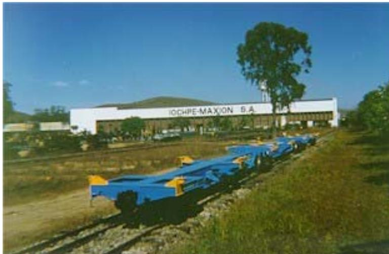
FIGURA 30: Roadrailer e vagão porta-contêineres
