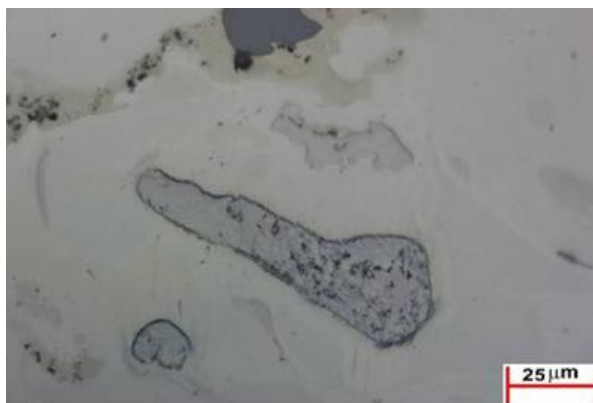
Figura34. Vista da camada com dos diferentes partículas duras, a superior, composto de silício e a inferior, de menor dureza, provavelmente, carboneto de tungstênio.
