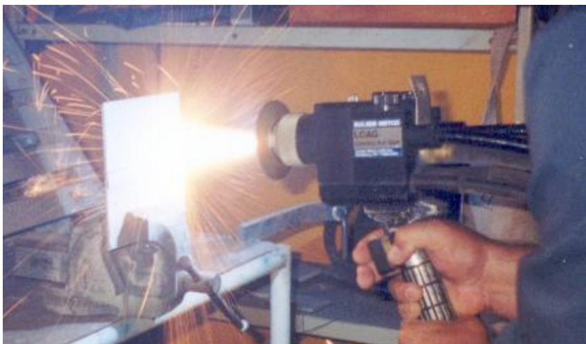
Figura 24. Posição da pistola durante a aspersão térmica.
