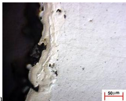
Figura 27a. Detalhe da qualidade da união entre camada - substrato e panquecas fundidas de material mais duro. Na figura 27b, a matriz de Ni contém FTC (cor café) colados numa estrutura fundida a base de Silício (cor cinza) e outras fases provavelmente de WC.
