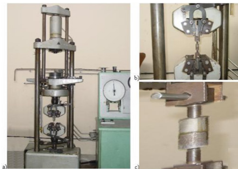
Figura 29. a) Prensa com o corpo de prova. b) Detalhe das garras com o dispositivo para manter as duas partes do “corpo de tração” num mesmo eixo. c) “Corpo de tração” pronto para o ensaio de tração.
