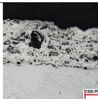
Figura17. Vista transversal, a interface camada-substrato mostra aderência interrompida, provavelmente por óxidos, além disso, é possível identificar partículas duras de grande tamanho.
