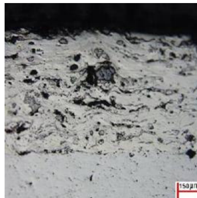
Figura 38. Vista transversal. Camada bem aderida ao substrato, CW/C2W de morfologia equiaxial e fundido em forma de lamelas e no centro, partícula de \text{SiO}_2 (a cavidade do lado é característica de material arrancado pelo lixamento).
