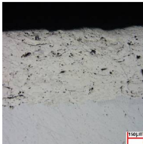
Fig 1 Vista transversal. Poros de forma irregular, sugerem arrancamento de partículas duras. A aderência da camada sem falhas (sem ataque).
