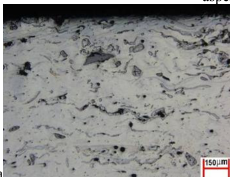
Figura30a. Vista transversal da camada, notasse a existência de partículas duras alongadas numa matriz homogênea e a partícula oxidada de silício no centro superior. O silício cristalizado representa uma interrupção na estrutura pela alta fragilidade dele. A função do Si é para formar ligas ou fases cerâmicas duras (Karl e Zum, 1987). Na figura 30b, representa uma vista perpendicular á camada mostrando partículas duras de FTC.
