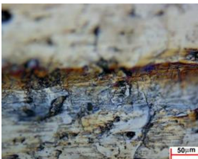
Figura 31 O material lateral flui mostrando que o mecanismo do desgaste é micro sulcamento.
