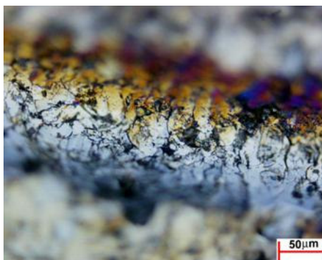
Figura 12.O risco mostra na trajetória a geração de trincas nas paredes do sulco, característico do risco onde existem micro-cortes.
