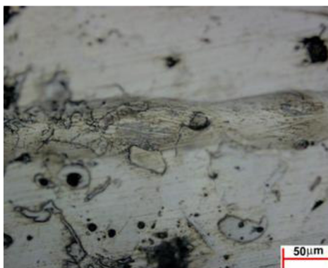
Figura 32. O material só foi deformado sendo uma matriz macia com partículas duras.
