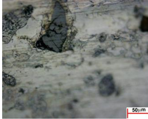
Figura 36. O indentador ao passar por sob a partícula dura de silício, incrusta-la na matriz, mais não foi arrancada.
