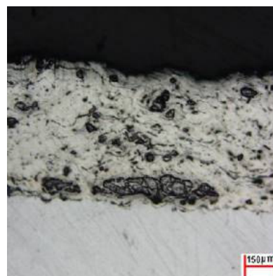
Figura 22 Vista transversal da camada destacam-se setores com colônias de partículas duras (FTC) bem na divisa com o substrato.
