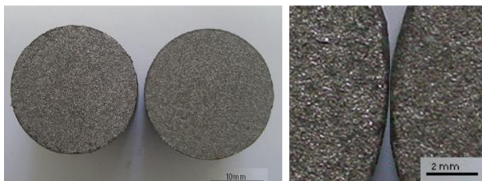
Figura 31 Falha tipo II, por coesão. A decoesão se gera na interface camada/camada
