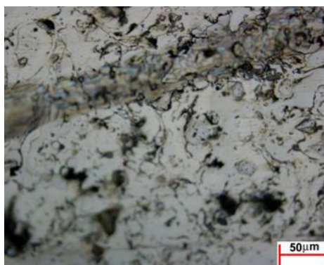
Figura 16. Os limites dos riscos indicam a existência de micro-cortes, assim como as paredes do sulco mostram trincas coerentes com esse mecanismo.
