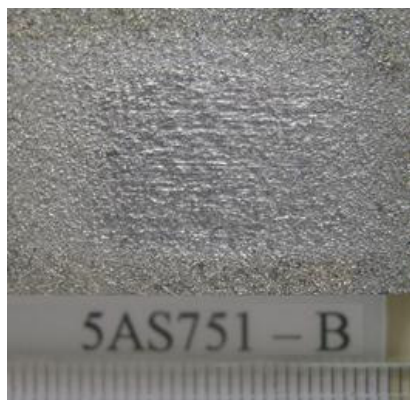
Figura 35a, procedimento C (30 segundos). Desgaste incipiente e figura 35b, procedimento B (10 minutos). Mostrando linhas de desgaste grosseiras.
