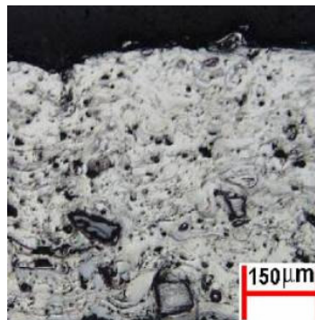
Figura 9. Vista lateral da camada Detalhe das partículas duras de diferentes tamanhos.
