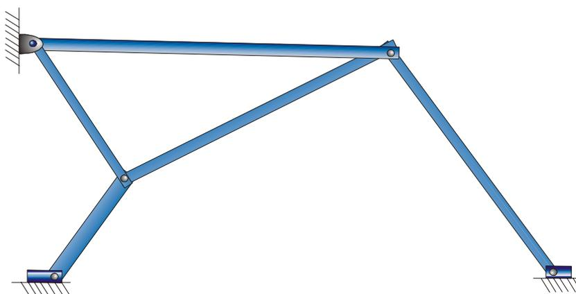
Figura 3.12: Mecanismo inversor de corpo rígido convencional
