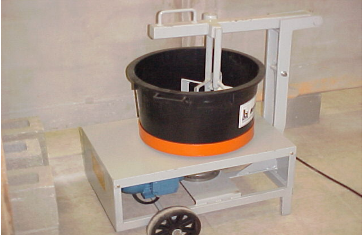
Fotografia 7 – Misturador de eixo vertical para produção das argamassas.
