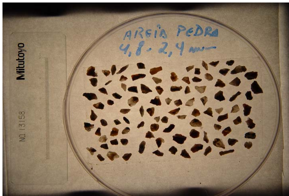
Fotografia 1 – Fixação dos grãos da fração 4,75 – 2,36mm da areia de pedra sobre fita adesiva.
