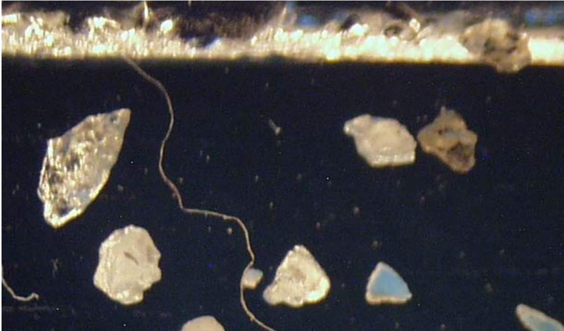
Fotografia 5 – Imagem de grãos de areia de rio, fração 0,600 -0,300, com detalhe da borda da fita adesiva
