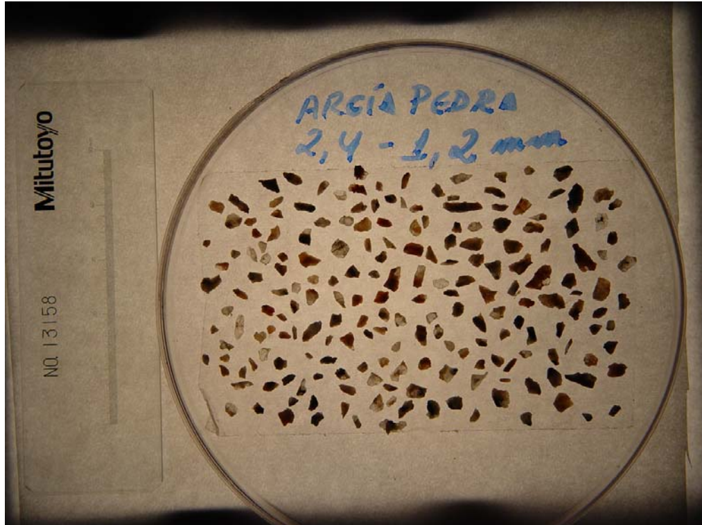
Fotografia 3 – Imagem de grãos da fração 2,36 – 1,18 mm, com detalhe da escala padrão.
