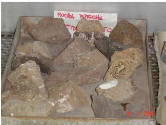
Figura 6-18 – Brecha basáltica antes do ensaio de abrasão.
