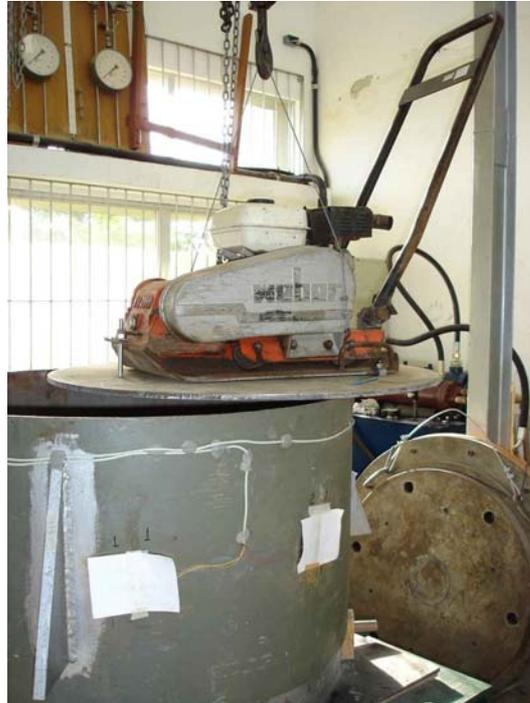
Figura 6-14 – Placa vibratória adotada.
