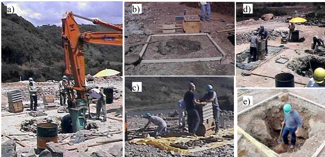
Figura 5-5 – Execução do ensaio de granulometria em campo.
