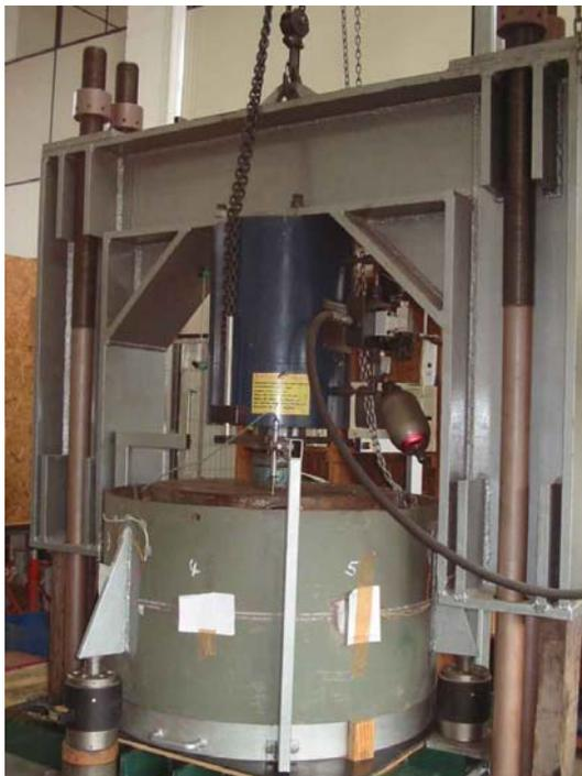
Figura 6-28 – Amostra montada e no local de aplicação da carga.
