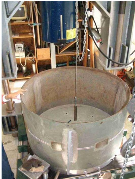
Figura 6-1 – Detalhe do anel de compressão unidimensional.
