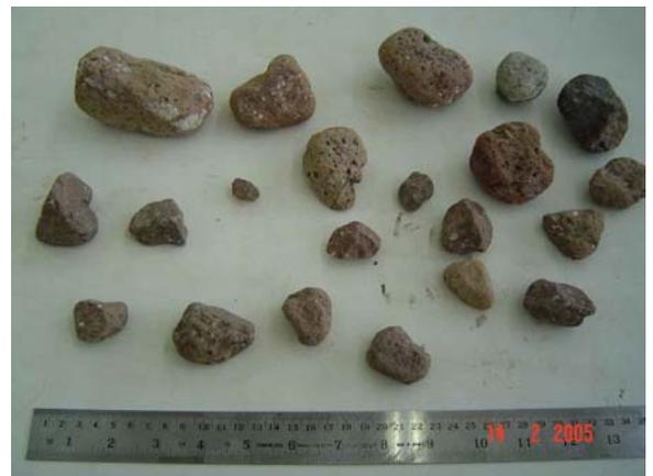
Figura 6-19 – Brecha basáltica após o ensaio de abrasão.
