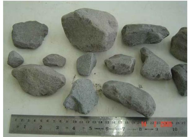
Figura 6-21 – Riodacito após o ensaio de abrasão.
