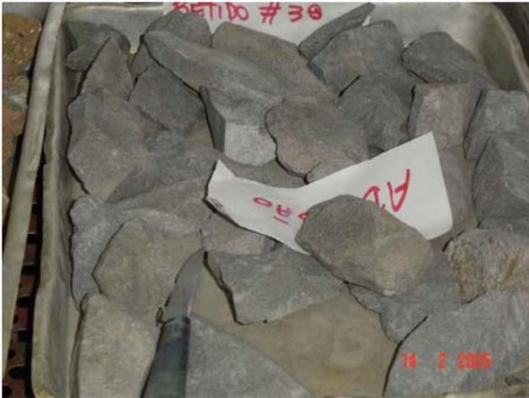
Figura 6-20 - Riodacito antes do ensaio de abrasão.
