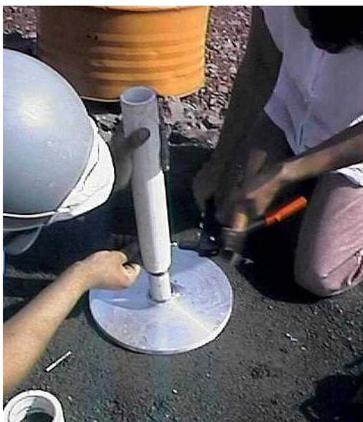
Figura 2-15 – Instalação de uma das placas do medidor magnético de recalque.
