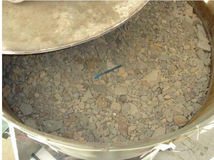
Figura 6-17 – Camada após a compactação.
