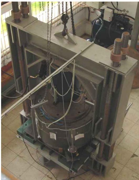
Figura 6-29 – Vista superior do equipamento de compressão unidimensional montado.
