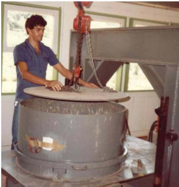
Figura 4-4 – Preparação do ensaio de compressão unidimensional.
