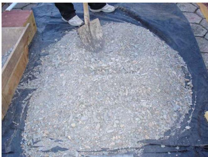
Figura 6-15 – Material homogeneizado.
