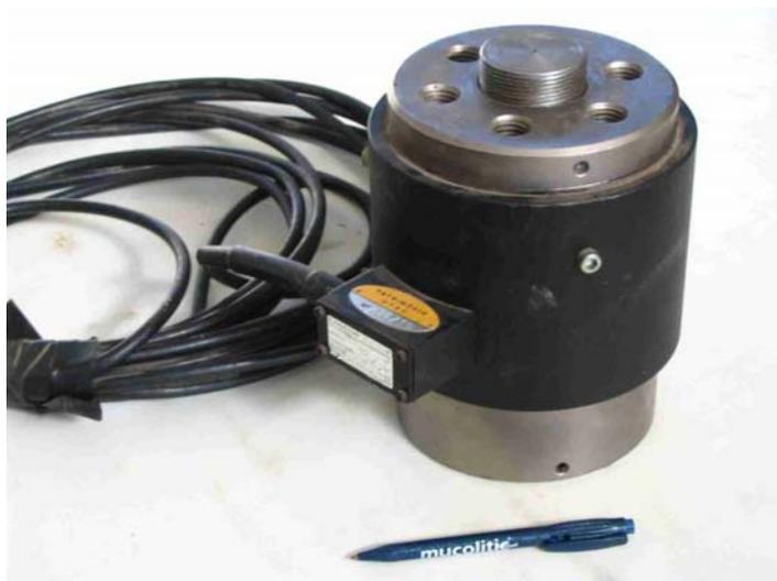
Figura 6-2 – Célula de carga.
