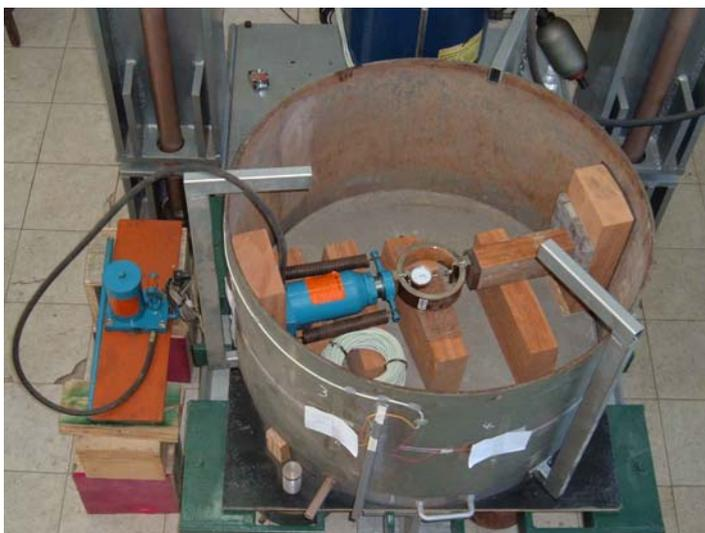
Figura 6-24 – Aplicação da carga em somente uma direção.
