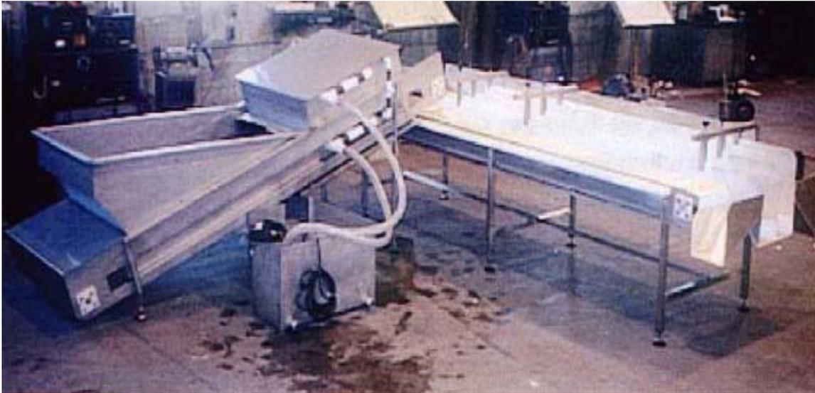
Figura 2.18 - Máquina de limpeza canadense, acoplada a um sistema de classificação do tipo passa-não-passa. Fukui Aquaculture (2003).
