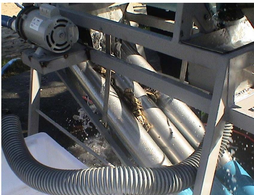
Figura 6.11 – Falha do conjunto classificador – congestionamento das guias.
