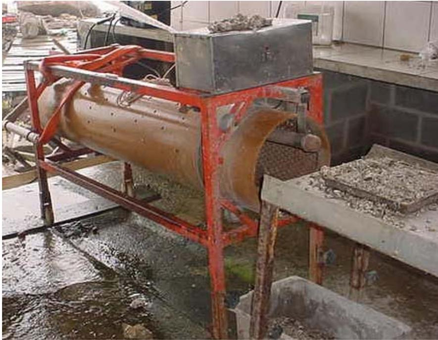
Figura 2.12 - Máquina tubular para limpeza de ostras.
