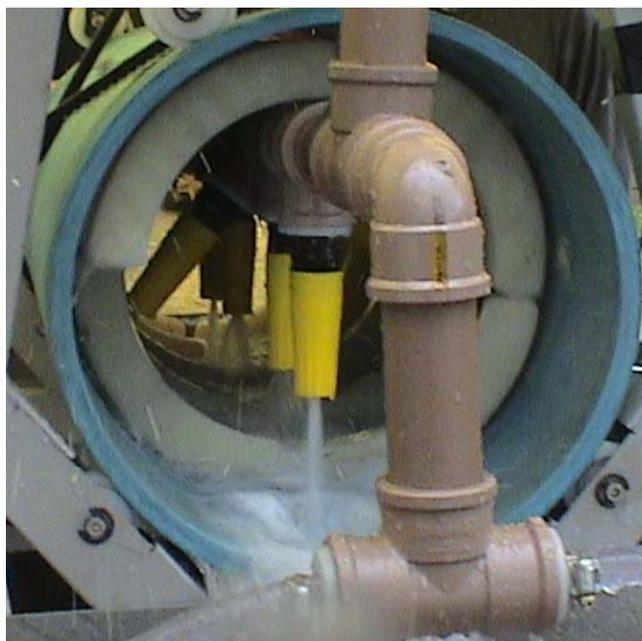
Figura 6.14 – Aspecto do funcionamento dos esguichos de limpeza.
