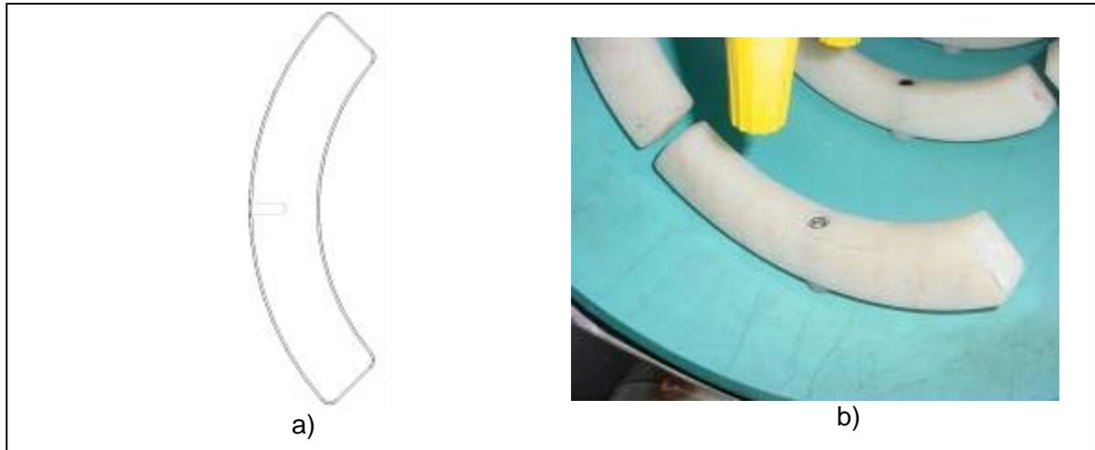
Figura 6.2 – Fixação das pás no tubo transportador.
