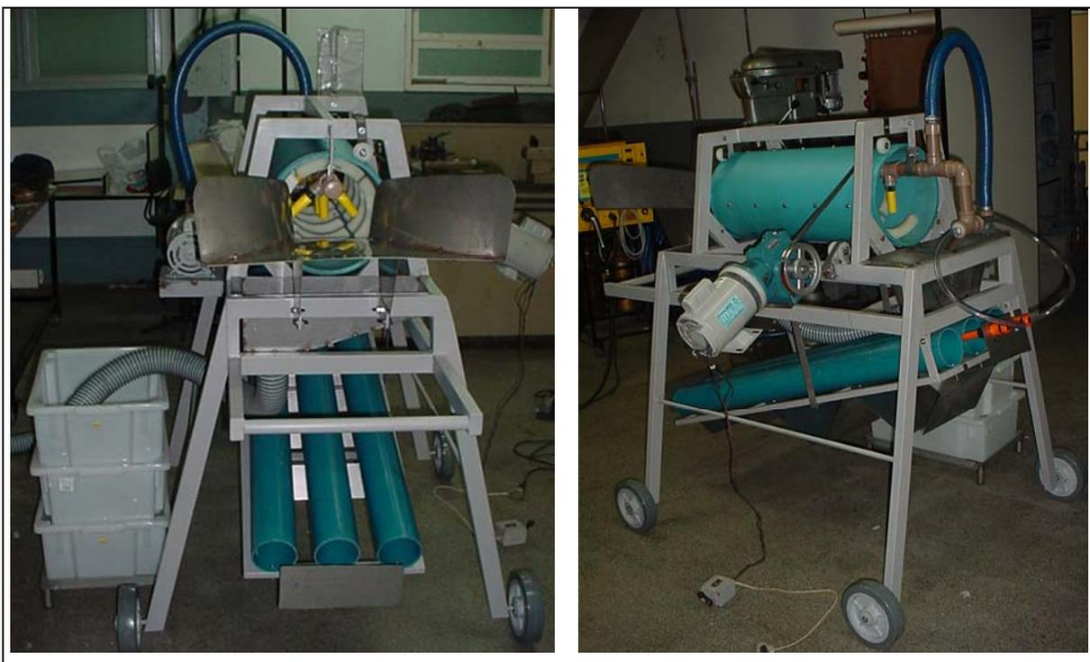
Figura 6.10 – Conjunto de sustentação – montagem completa.
