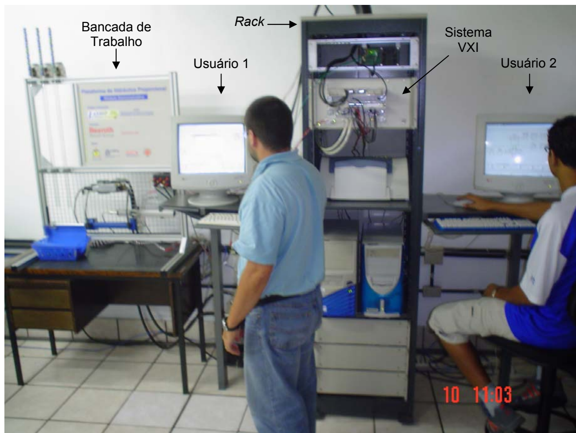
Figura 1.4 – Equipamento utilizado atualmente no LASHIP para o controle de posição de sistemas hidráulicos.
