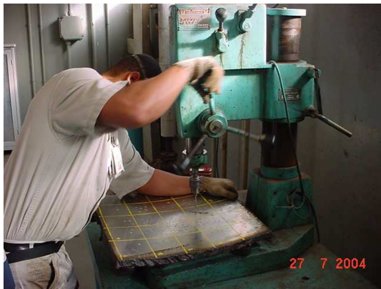
Figura 3.1: Preparação dos corpos de prova (perfurações mecânicas) com uso de furadeira de bancada, para simulação de pites isolados e agrupados.
