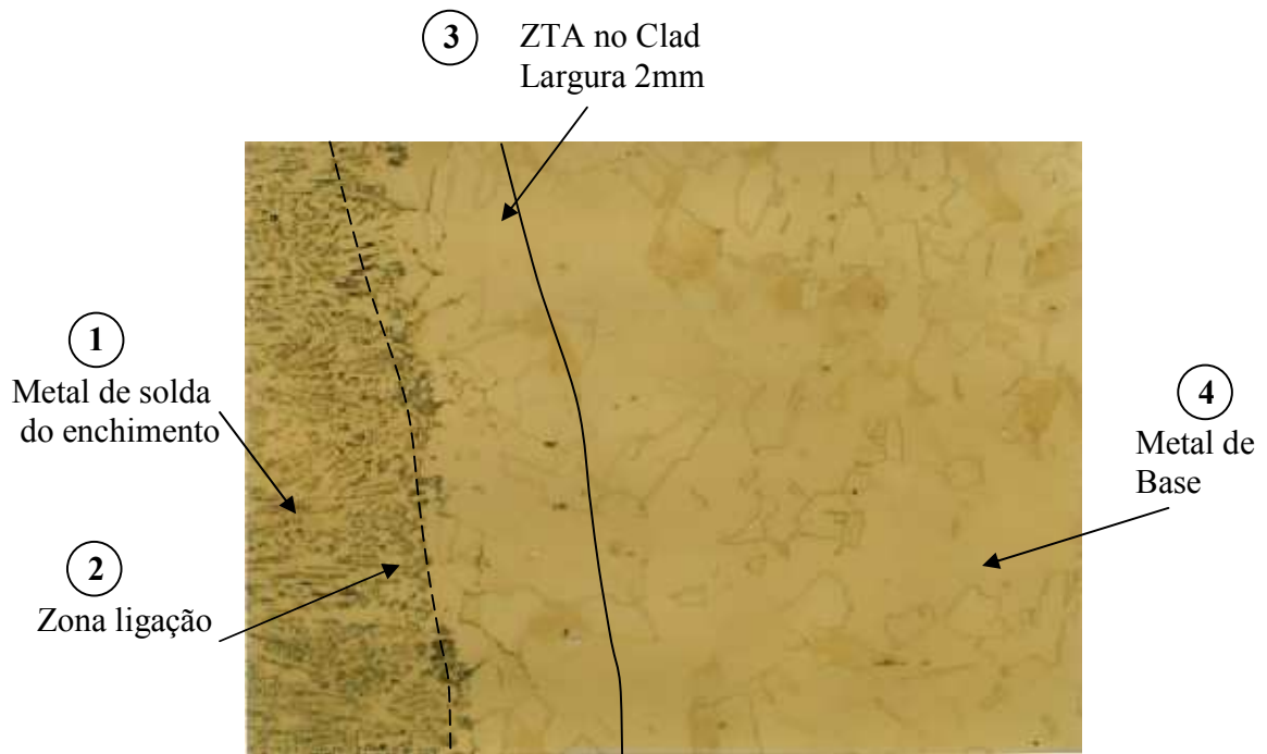
Figura 4.23: Corpo de Prova-26. Região da linha de fusão / Z.T.A do enchimento. Microestrutura da Z.T.A. constituída de matriz austenítica solubilizada sem anormalidades e também isenta de susceptibilidade à corrosão intergranular. Aumento: 200X. Ataque: Ac. Oxálico 10% eletrolítico.
