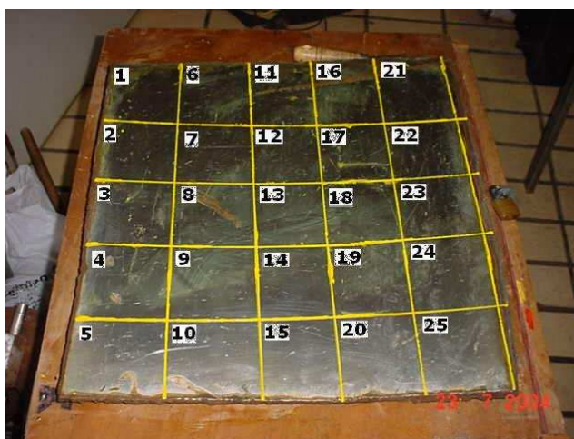
Figura 3.5: Divisão de chapa ASTM 516 Gr 70 (19 mm) cladeada com 304 L (3 mm) em corpos de prova de 100 x 100 mm onde foram inseridos pites profundos isolados e agrupados.
