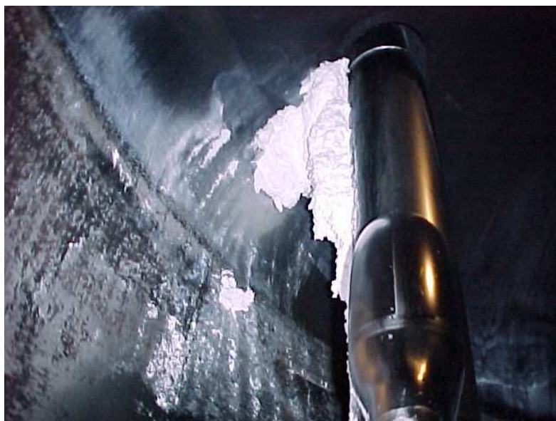
Figura 1.1 – Detalhe do produto polimerizado aderido às paredes do reator (Relatório de inspeção CPC, 1994)
