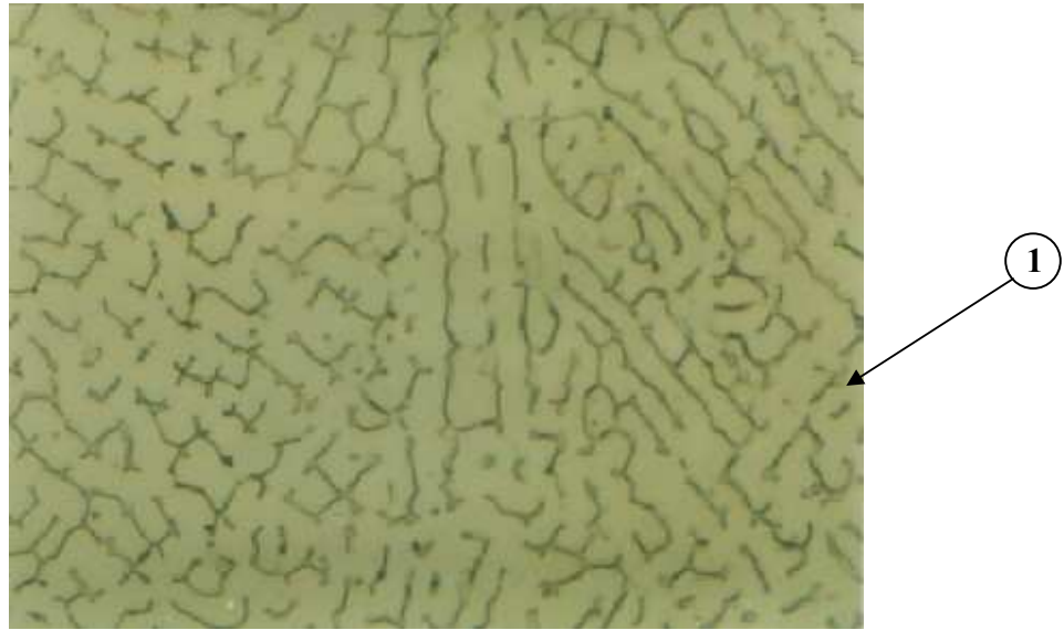
Figura 4.30: Corpo de Prova-35. Metal de solda, mesma região da foto anterior com aumento de 1000X, evidenciando matriz austenítica e ferrita delta com morfologia vermicular.
