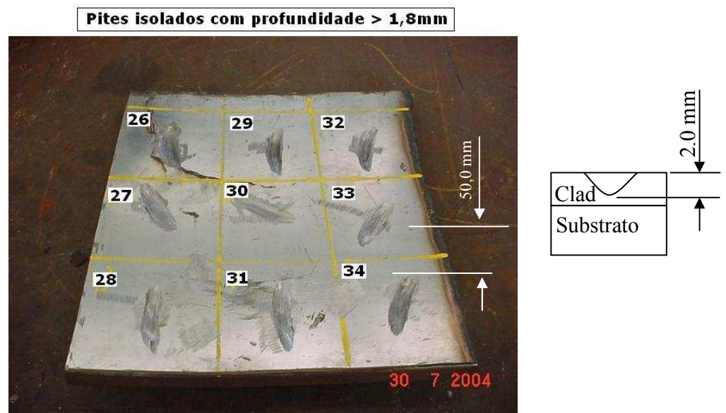
Figura 3.11: Corpos de prova de 26 a 34, simulando pites isolados profundos.
