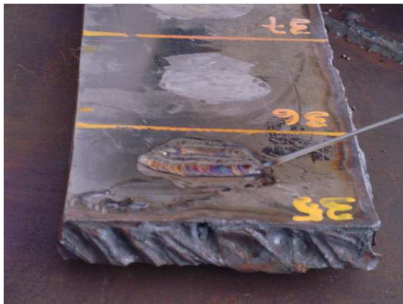
Figura 4.1c: Corpo de prova com simulação de pites isolados rasos recuperados pela aplicação com TIG-P e TIG convencional.
