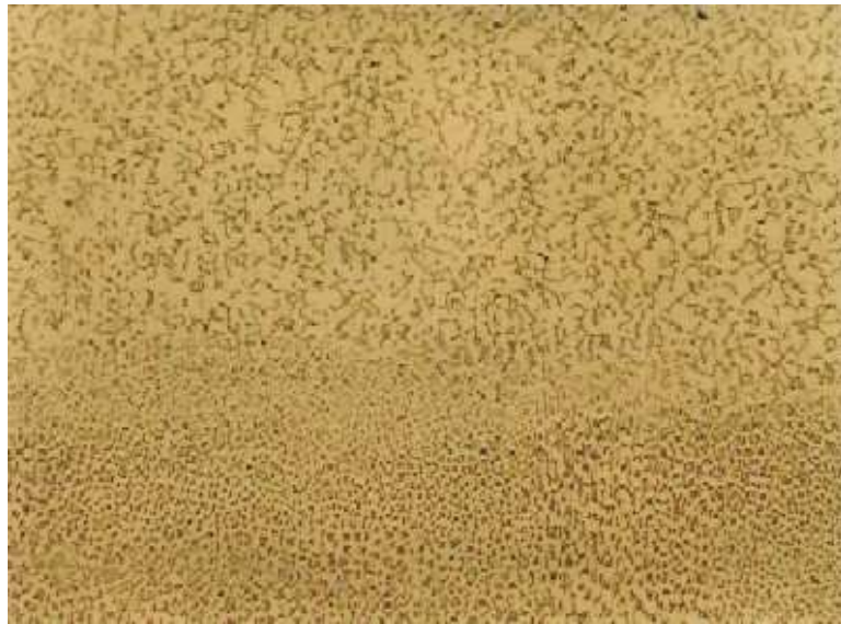
Figura 4.17: Corpo de Prova-19. (MIG pulsado) Metal de solda/enchimento. Microestrutura dendrítica bastante fina, também isenta de anormalidades. A diferença de textura mais fina e com grãos maiores, deve-se a dois passes de enchimento, caracterizando fusão homogênea entre os dois passes de solda. Aumento: 200X. Ataque: Ac. Oxálico 10% eletrolítico.
