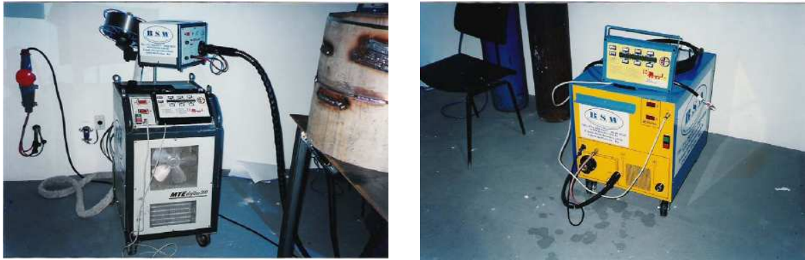
Figura 3.13: Máquinas com controle eletrônico multiprocesso usada na qualificação dos procedimentos e soldadores.
