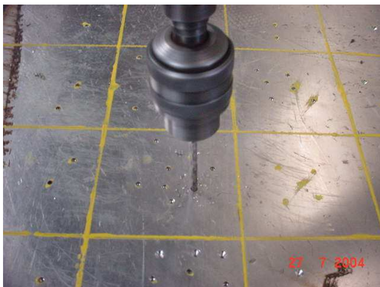
Figura 3.2: Simulação mecânica de defeitos (similares aos pites) na chapa 516 Gr 70 cladeada em 304 L, com controle de profundidade dos defeitos inseridos na chapa de 3 mm de 304 L + 19 mm de aço carbono
