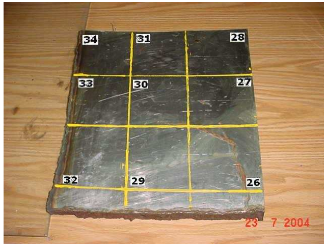
Figura 3.6: Divisão da chapa 516 Gr 70 + clad em 304 L em corpos de prova de 100 x 100 mm onde foram inseridos pites isolados.
