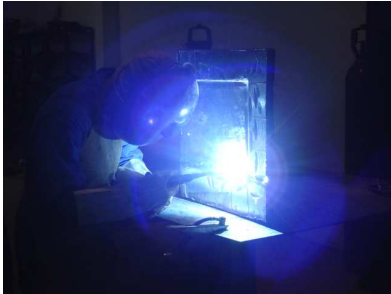
Figura 4.1b: Soldagem do corpo de prova com pites agrupados rasos e profundos com MIG-P e MIG convencional.
