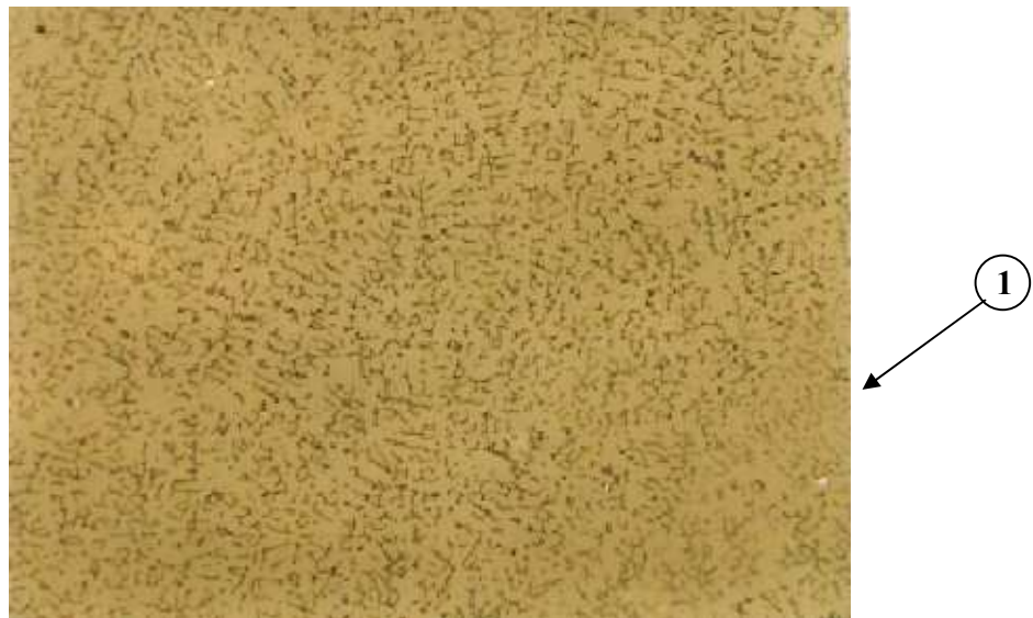
Figura 4.11: Corpo de Prova-22.(MIG pulsado) Metal de solda/enchimento. Registra-se matriz austenítica com ilhas de ferrita delta nos contornos dendríticos isentos de precipitação de carbonetos. Aumento 200X. Ataque: Ac. Oxálico 10% eletrolítico.
