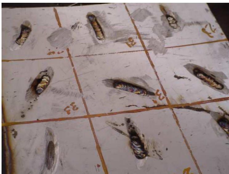
Figura 4.1a: Corpo de prova com pites simulados isolados após a recuperação por deposição dos cordões de solda.
