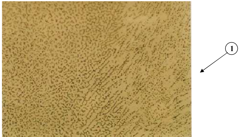
Figura 4.14: Corpo de Prova-7. (MIG convencional) Metal de solda/enchimento. Microestrutura dendrítica muito fina isenta de anormalidades. Observa-se textura dendrítica equiaxial e levemente colunar. Aumento de 200X. Ataque: Ac. Oxálico 10% eletrolítico.
