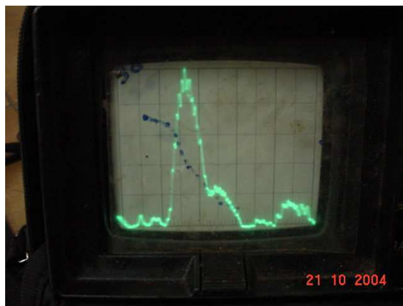
Figura 4.5: Detalhe do eco observado no ensaio de ultra-som do corpo de prova 32 oriundo de um descolamento localizado do clad.
