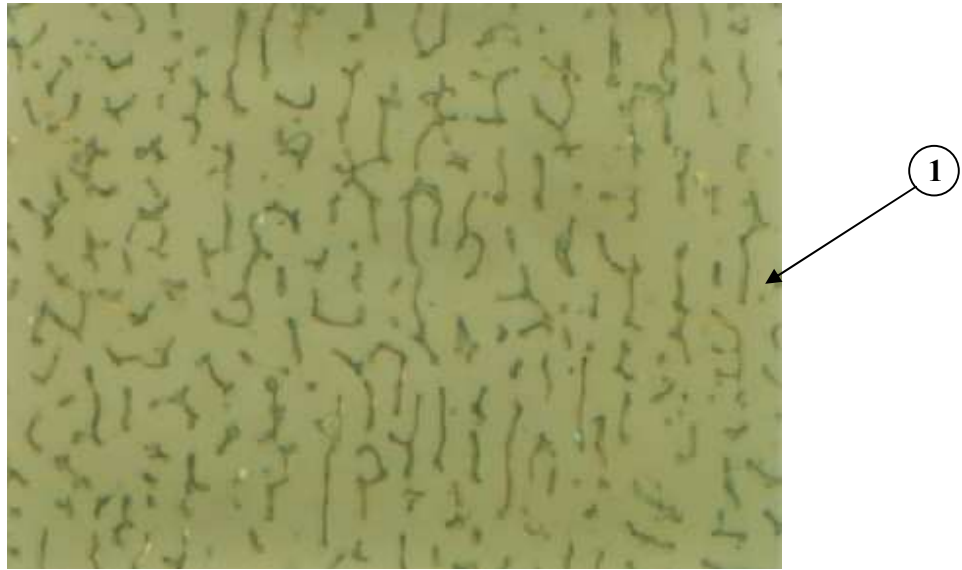
Figura 4.27: Corpo de Prova-31. Metal de solda, mesma região das fotos anteriores com aumento de 1000X, evidenciando ausência de carbonetos nos contornos dendríticos, condição que isenta esta região de susceptibilidade à corrosão intergranular. Ataque: Ac. Oxálico 10% eletrolítico.
