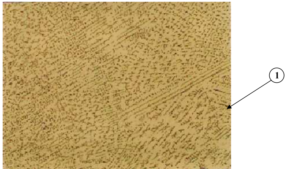
Figura 4.28: Corpo de Prova-35. (TIG pulsado) Metal de solda/enchimento. Microestrutura dendrítica equiaxial e levemente colunar com textura muito fina, isenta de anormalidades. Aumento: 200X. Ataque: Ac. Oxálico 10% eletrolítico.
