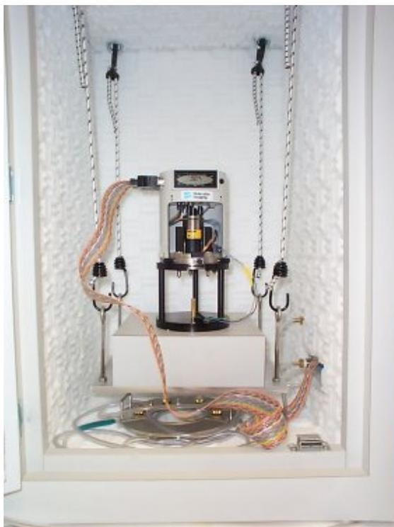
**Figura III.7:** Fotografia do Microscópio de Força Atômica utilizado neste trabalho.
