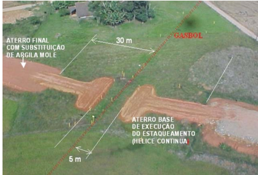
FIGURA 66 – Cruzamento de uma nova rodovia sobre duto em região de solo mole. Fonte: VASCONCELLOS et al., 2005, p. 8.
