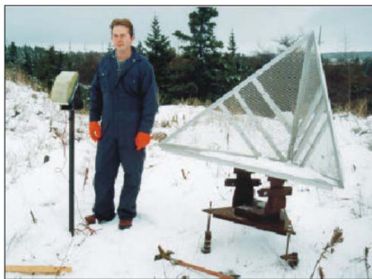
FIGURA 44 - Cones refletivos para melhorar a intensidade de energia captada pelo satélite. Fonte: O'NEIL e SAMCHEK, 2002, p. 10.
