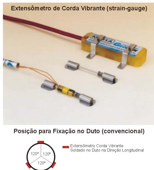
FIGURA 52 – Extensômetro de corda vibrante e pontos de instalação em dutos. Fonte: GEOKON, 2005 (modificado pelo autor).
