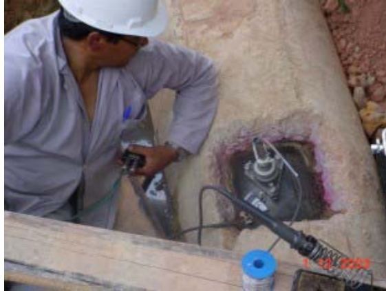
FIGURA 49 – Aparato de perfuração para medição de tensões em dutos. Fonte: Arquivo TBG, 2004.
