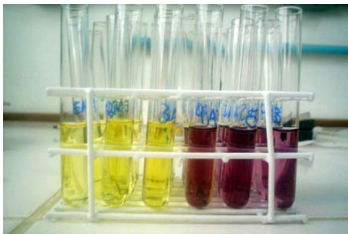
Figura 29 – Foto DPPH para condição de 300 bar/40 °C.
