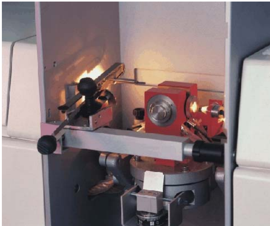
Figura 4. Espectrômetro de absorção atômica equipado com acessório para a introdução manual direta de amostra sólida.
