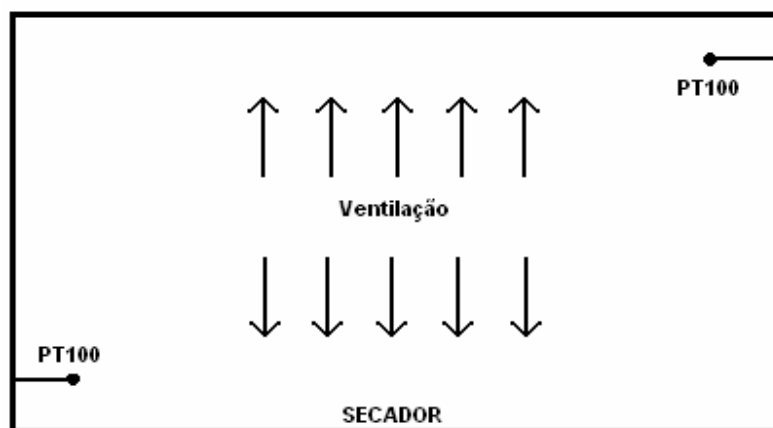
Figura 3.1. Estrutura do sistema de medição do sistema original.
