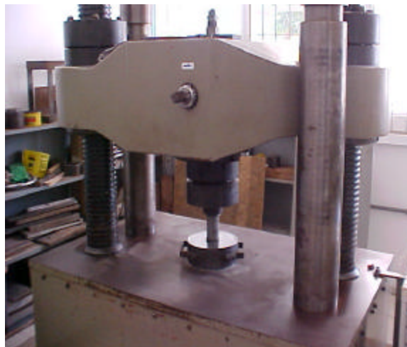
Figura 37 – Vista da prensa utilizada no ensaio de resistência à compressão de corpos-de-prova de argamassa
