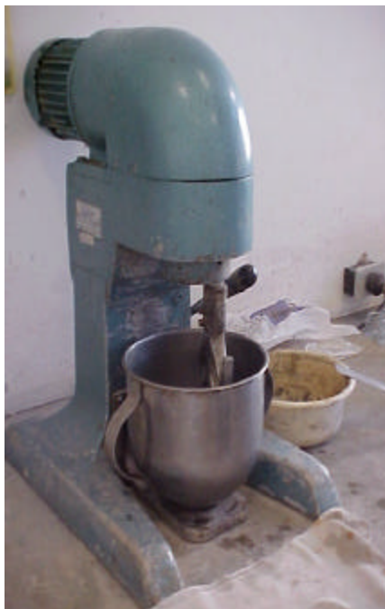
Figura 34 – Argamassadeira empregada na produção das pastas
