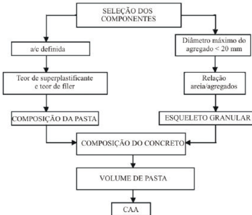
Figura 16 – Fluxograma do método de dosagem para CAA de alta resistência (GOMES, 2002)
