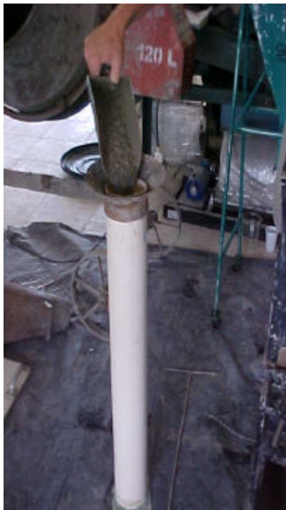
Figura 43 – Molde para ensaios de exsudação, massa específica e teor de vazios
