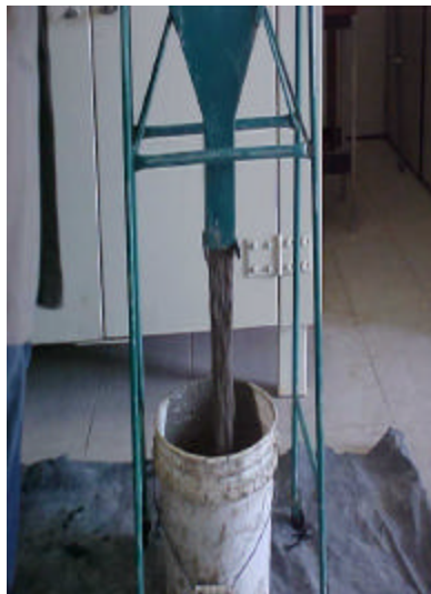
Figura 41 – Ensaio do Funil-V
