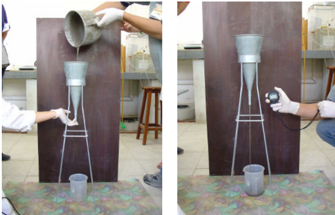
Figura 35 – Ensaio do Cone de Marsh para determinação do teor de saturação do aditivo
