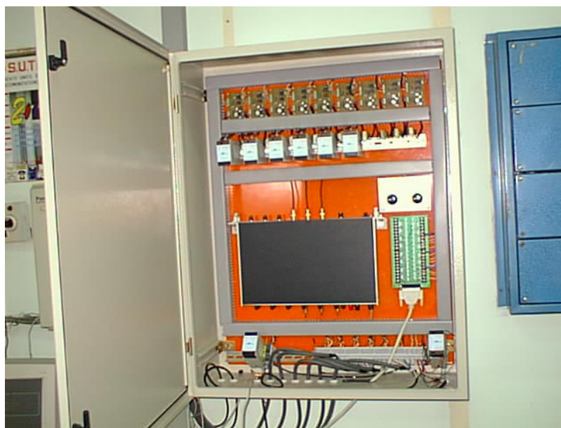
Figura 5-16 Circuitos da placa amplificadora do sinal de acelerômetros e da placa conversora analógico digital
