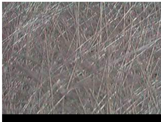
Figura 2.7: Manta de fios picados – chopped strand mats , (Santos Neto, 2004).
