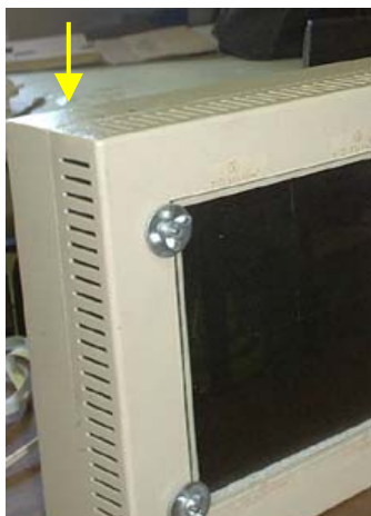
Figura 52. Aberturas laterais (antes da modificação).
