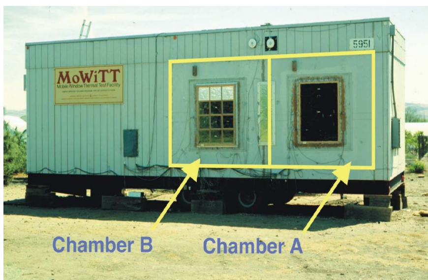
Figura 22. Sistema MoWiTT mostrando as duas câmaras operando de forma independente.
