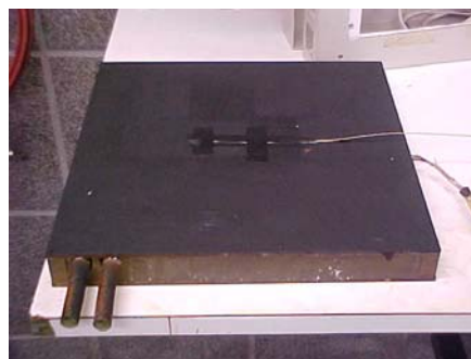
Figura 34. Placa de circulação de água.
