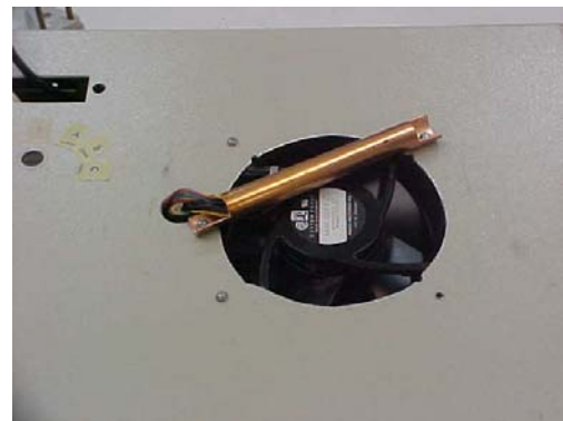
Figura 45. Junção de referência dos termopares na entrada do ventilador.
