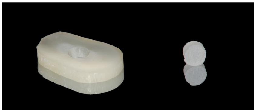
Figura 39 – Fatia e pino após a extrusão
