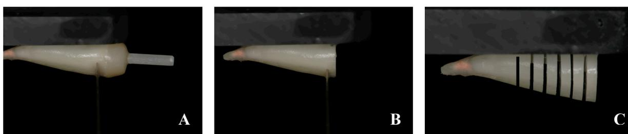
Figura 31A-C – Realização das secções transversais para a obtenção dos corpos-de-prova
