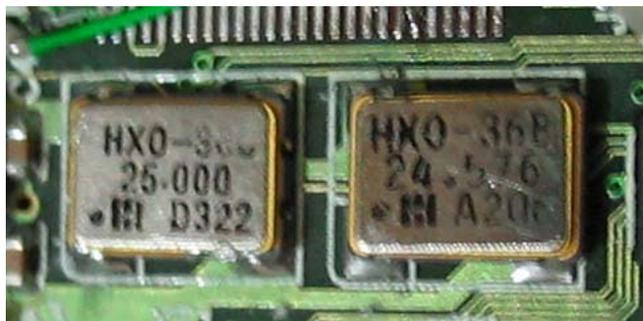
FIGURA 3.1 – OSCILADORES DE 25MHZ E 24,576MHZ MONTADOS NO PCB DO ATA
