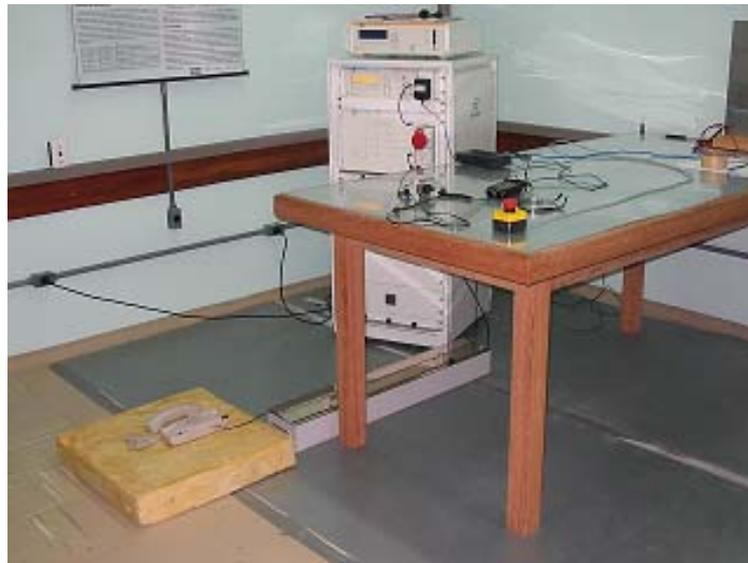
FIGURA 5.5 – SETUP DE TESTES DE EFT/BURST UTILIZANDO CLAMP CAPACITIVO.
