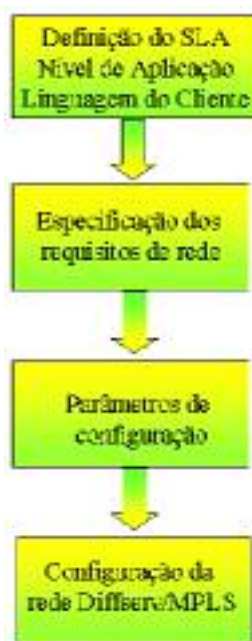
Figura 6.1 – Etapas para especificação do SLA VoIP até a configuração da estrutura de rede
