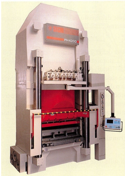
Figura 2.3. Prensa utilizada para conformação de porcelanato. Fonte: Emiliani e Corbara, 2001 [23].
