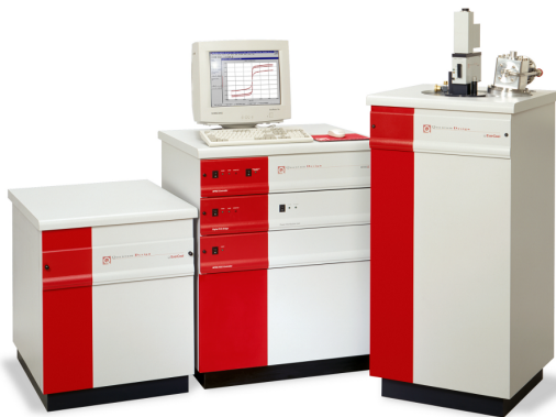
Figura 3.6: MPMS fabricado pela empresa Quantum Design © . Fonte: Quantum Design Website .
