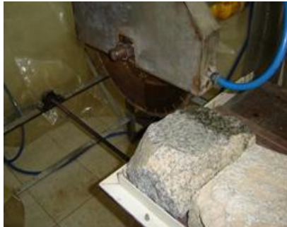
Figura 3-9 Primeira tentativa de corte, serra do laboratório de solos.
