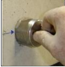
Figura 2-7 Transdutor plano de 50,0 mm e 54 kHz.
