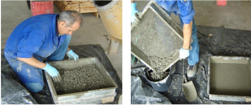
Figura 3-17 Procedimento adotado para obtenção da argamassa.
