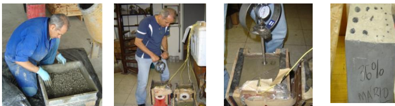
Figura 3-20 Procedimentos para o ensaio de início e fim de pega concreto.
