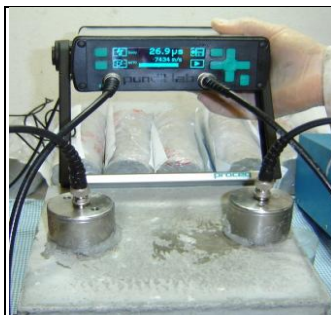
Figura 2-11 Arranjo dos transdutores para medição indireta.
