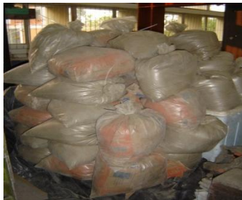
Figura 3-7 Forma de armazenamento dos cimentos
