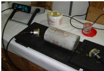
Figura 3-26 Determinação da velocidade em corpos de prova de concreto.
