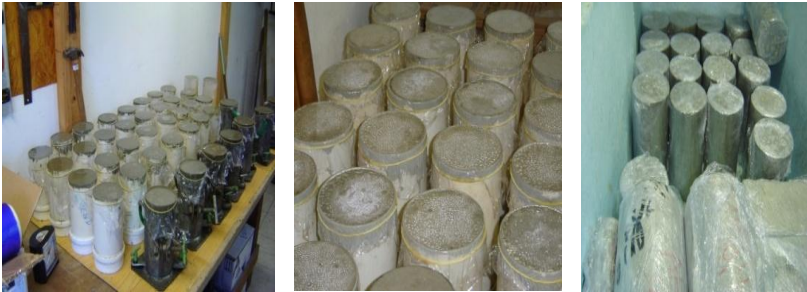
Figura 3-21 Vedação dos corpos de prova, armazenamento nas primeiras 24 horas e armazenamento para as idades mais avançadas.
