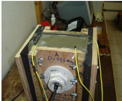
Figura 3-15 Dispositivo com pasta, leitura da velocidade de pulsos ultrassônicos a partir do estado fresco e monitoramento da temperatura com termopar tipo “K”
