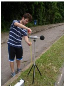
Figura 5.15 - Posicionamento do Sonômetro (km 9+400).
