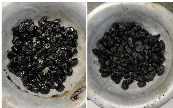
Figura 4.2 - Resultado do ensaio de adesividade (a esquerda: ligante comum, a direita: ligante modificado com borracha)
