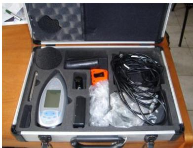
Figura 5.8 - Equipamento SOLO N<sup>o</sup> 1163q Classe 1 da marca 01 dB-Metravib.
