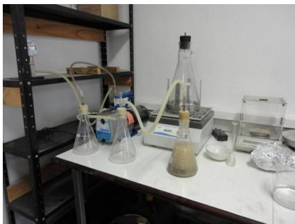
Figura 4.7 - Ensaio da massa específica máxima – procedimento à vácuo
