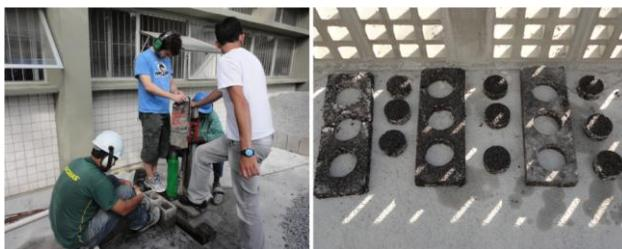
Figura 4.20 - Extração dos Cps das placas de concreto asfáltico
