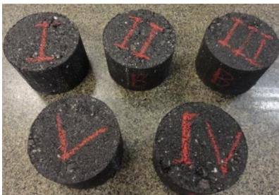
Figura 4.15 - Corpos de prova Marshall (mistura asfalto-borracha)
