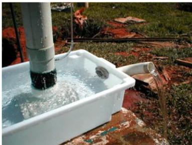
Figura 2.57 - Ensaio de drenabilidade horizontal (OLIVEIRA, 2003).
