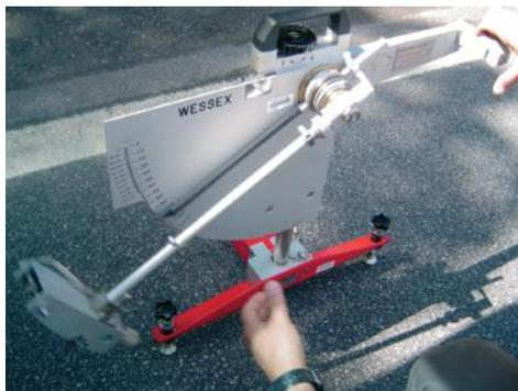
Figura 2.48 - Ensaio do pêndulo britânico (BERNUCCI *et al.*, 2007).
