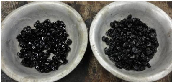
Figura 4.1 - Preparação do ensaio de adesividade (a esquerda: ligante comum, a direita: ligante modificado com borracha)
