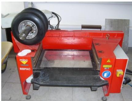
Figura 3.3 - Compactador de placas LCPC.
