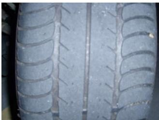
Figura 5.11 - Detalhes das ranhuras de um dos pneus Goodyear 205/55 R15 91V usado neste experimento.
