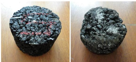
Figura 4.21 - Corpo de prova Marshall antes e depois do ensaio de Cântabro (CPA)
