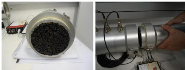
Figura 4.23 - Colocação da amostra no tubo de impedância
