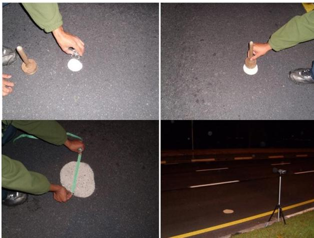
Figura 5.13 - Ensaio da mancha de areia realizado no revestimento asfalto-borracha.
