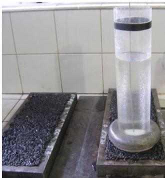
Figura 2.56 - Ensaio de drenabilidade em placas (carga variável) (DUMKE, 2005).
