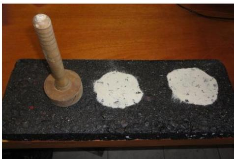
Figura 4.19 - Ensaio de mancha de areia nas placas de concreto asfáltico
