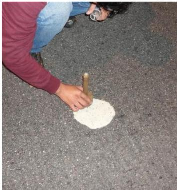
Figura 5.31 - Ensaio da mancha de areia realizado no microrrevestimento
