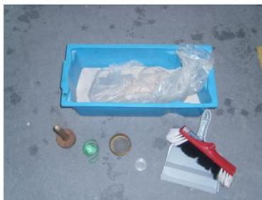
Figura 3.5 - Equipamentos do ensaio da mancha de areia
