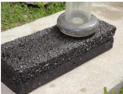
Figura 4.18 - Drenabilidade das placas de concreto asfáltico
