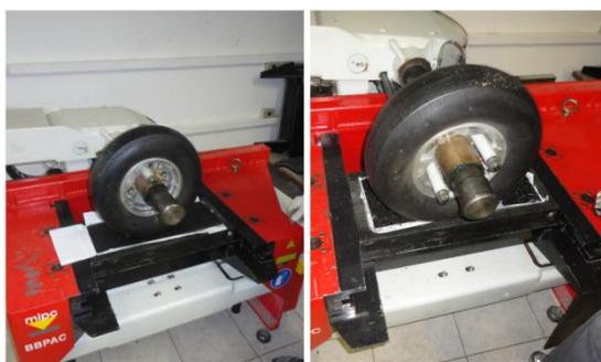
Figura 4.17 - Procedimento de compactação das placas
