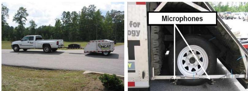
Figura 2.32 - Equipamento de ensaio do método CPX (HANSON *et al.*, 2005).
