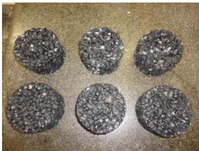
Figura 4.13 - Mistura asfáltica drenante
