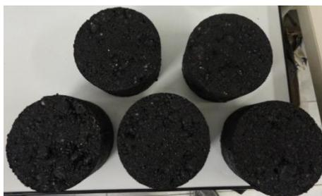
Figura 4.12 - Corpos de prova Marshall (mistura asfáltica densa comum)
