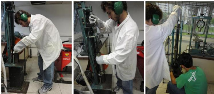
Figura 4.11 - Execução da compactação Marshall
