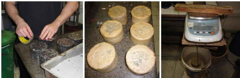
Figura 4.14 - Ensaio da determinação da massa específica aparente com parafina
