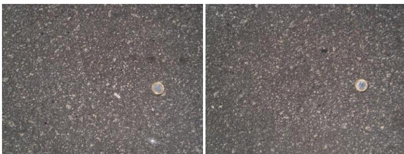
Figura 5.22 - Textura da Superfície local de medição próximo Restaurante Habib's (antes da restauração).
