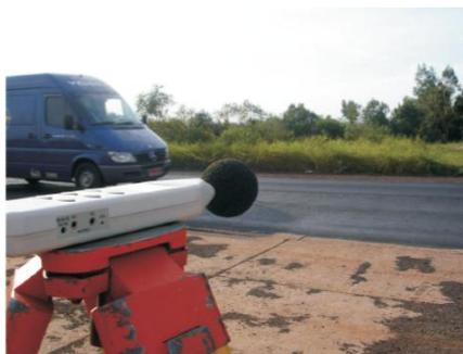
Figura 2.29 - Medida do ruído pelo método estatístico de passagem (SPB) (CERATTI *et al.*, 2009).
