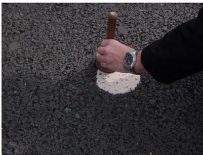
Figura 5.27 - Ensaio da mancha de areia realizado na CPA
