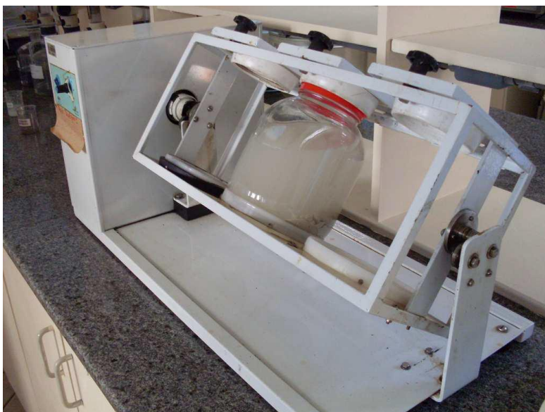
Figura 13. Agitador Rotatório de Frasco, equipamento utilizado para a lixiviação. Foto: (COSTA, 2010)
