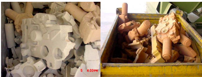
Figura 12. Exemplos de subprodutos do sistema de areias quimicamente ligadas. Fonte: (MASIERO, 2002)
