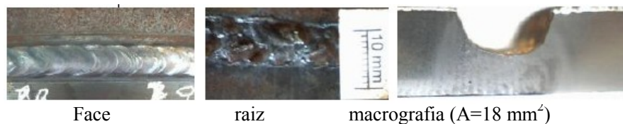
Figura 4-32 – Solda 5G, cordão A, pulsado de 0,24 Hz.
