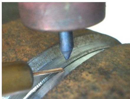
Figura 4-1 – Situação de soldagem 1G com alimentação radial.
