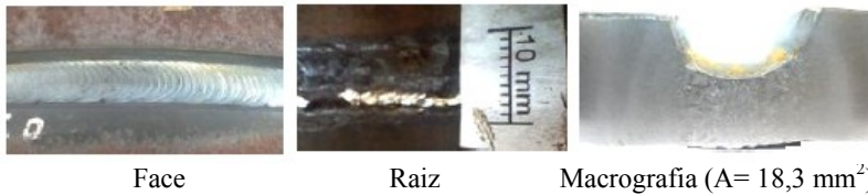
Figura 4-33 – Solda 5G, cordão C, com pulsado de 1 Hz.
