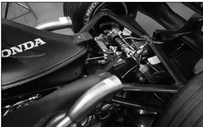
Figura 5: Compósito de matriz epóxi reforçado por fibra de carbono na suspensão e na caixa de engrenagens em carros de corrida de fórmula 1 (MALLICK, 2007).
