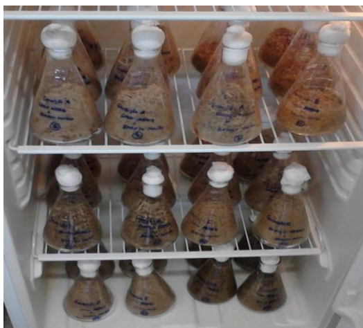
Figura 8: Cultivo em estado sólido realizado em frascos.
