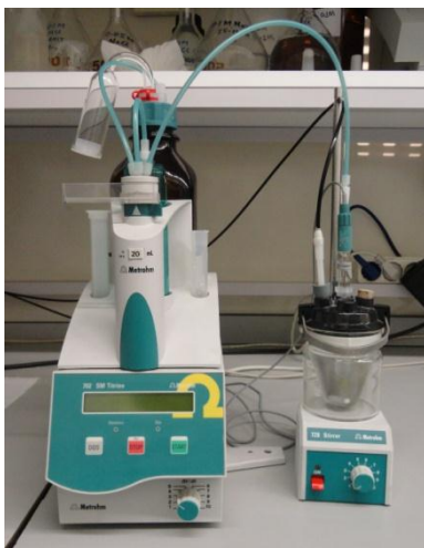
Figura 14 - Titulador automático com módulo de agitação (Metrohm)
