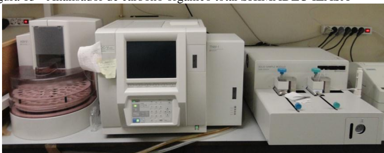
Figura 13 - Analisador de carbono orgânico total SHIMADZU IZASA
