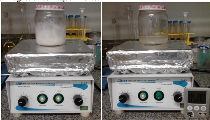
Figura 17 – Experimentos de extração de cromo em sistemas emulsionados em agitador magnético com aquecimento.
