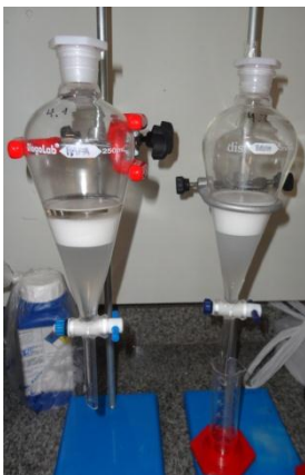
Figura 15 - Separação de fase do sistema emulsionado em aparelho dispersor ultra turrax.
