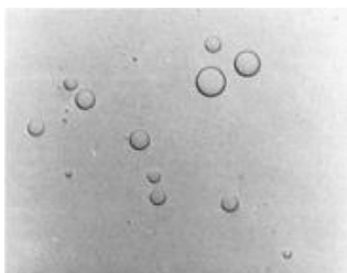
Figura 6 - Fenômeno de coalescência observado por microscopia óptica.
