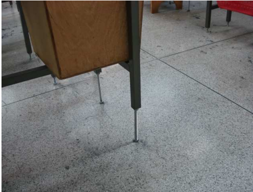
Figura 12 – Sistema de ajuste da altura da bancada
