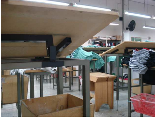
Figura 11 – Sistema de inclinação da bancada
