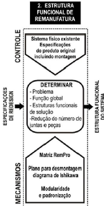
Figura 32: Fase 2 - Estrutura Funcional de Remanufatura
