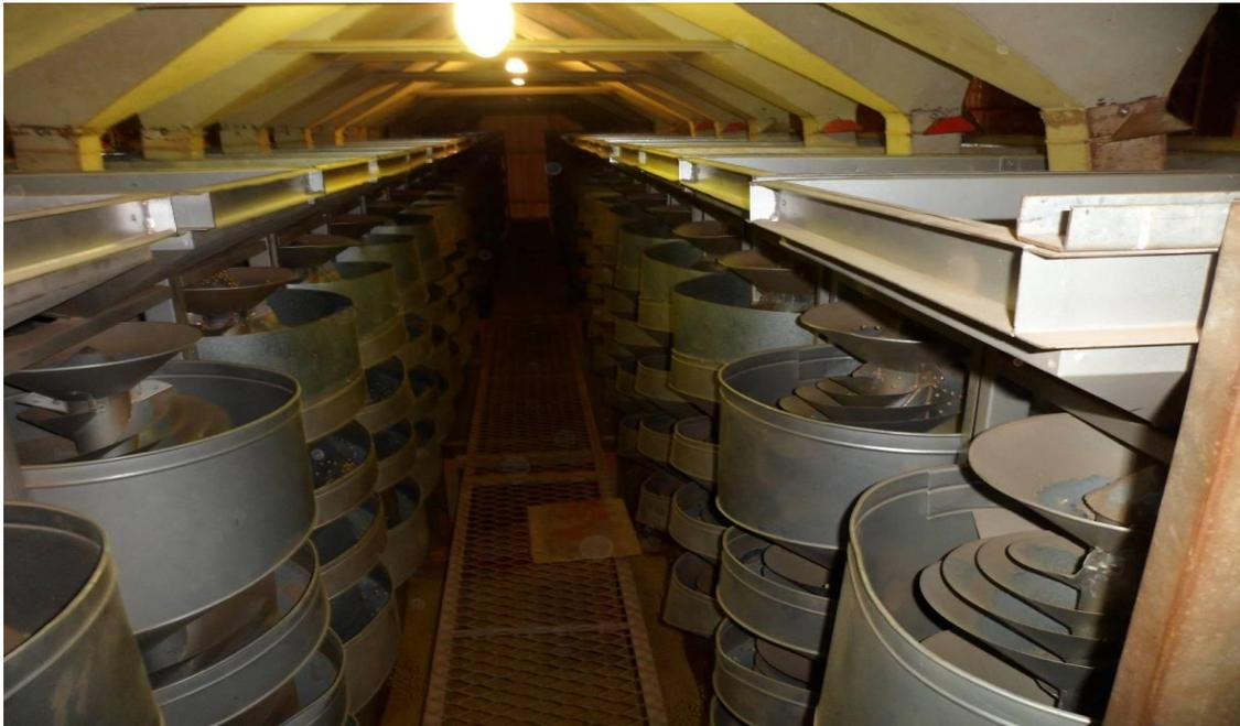
**Figura 6:** Conjunto de sistema de espiral que separa sementes pela forma, sendo alimentada pelos silos. Fonte: Douglas Martinello (2012).
