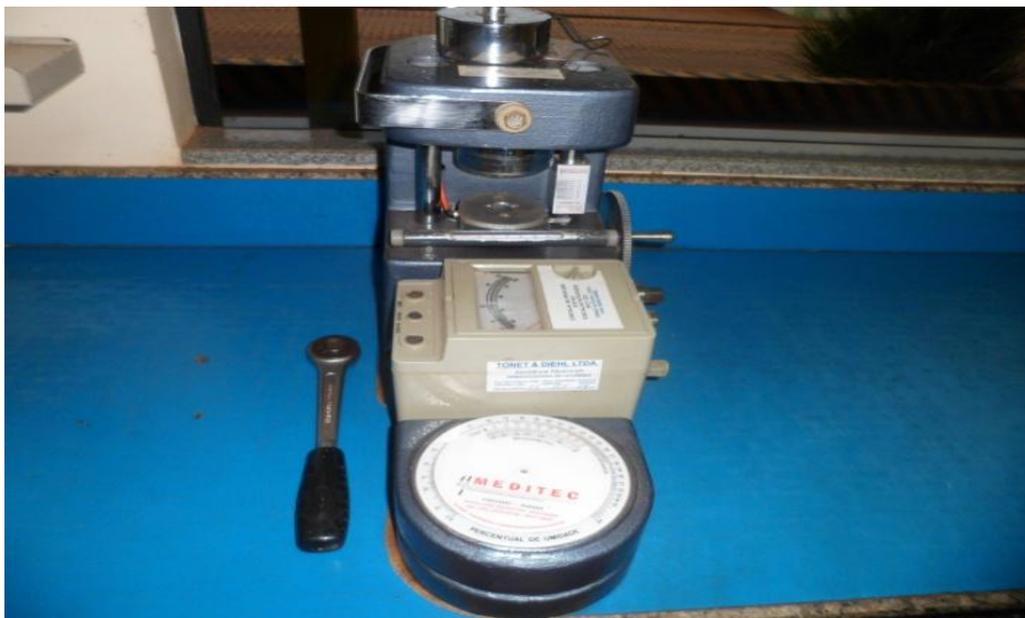
**Figura 2:** Medidor de umidade de sementes universal, na recepção das sementes da empresa Bocchi Agronegócios. Fonte: Jonas C. Reisdorfer (2012).
