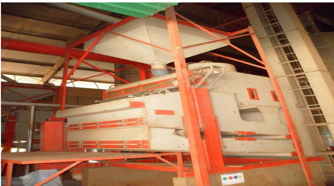
**Figura 5:** Máquina de pré- limpeza, na unidade de beneficiamento de sementes (UBS).
