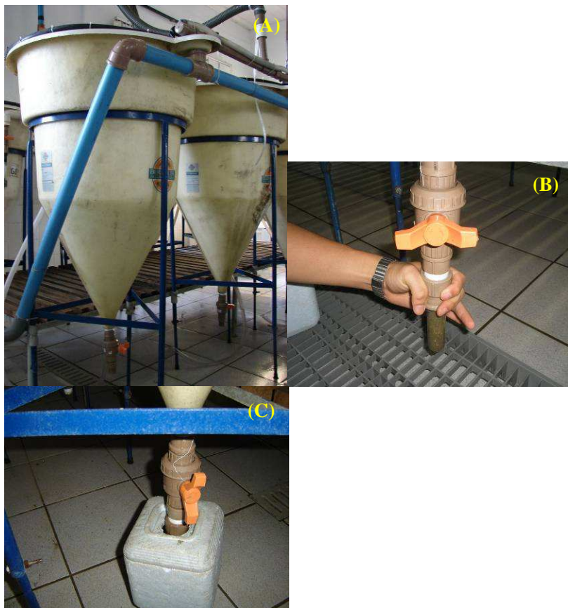
Figura 3. Ensaio de digestibilidade. (A) Unidades experimentais. (B) Tubo coletor de fezes por sedimentação. (C) Isopor com gelo durante coleta de fezes.
