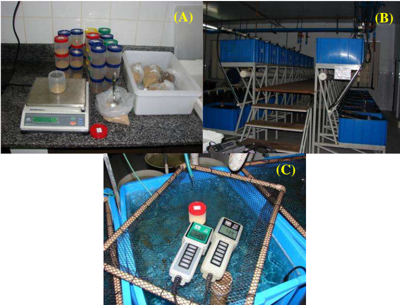
Figura 1. Ensaio de desempenho e fisiologia intestinal. (A) Pesagem diária das dietas experimentais a serem fornecidas duas vezes ao dia. (B) Unidades experimentais. (C) Medida rotineira dos parâmetros de qualidade de água.
