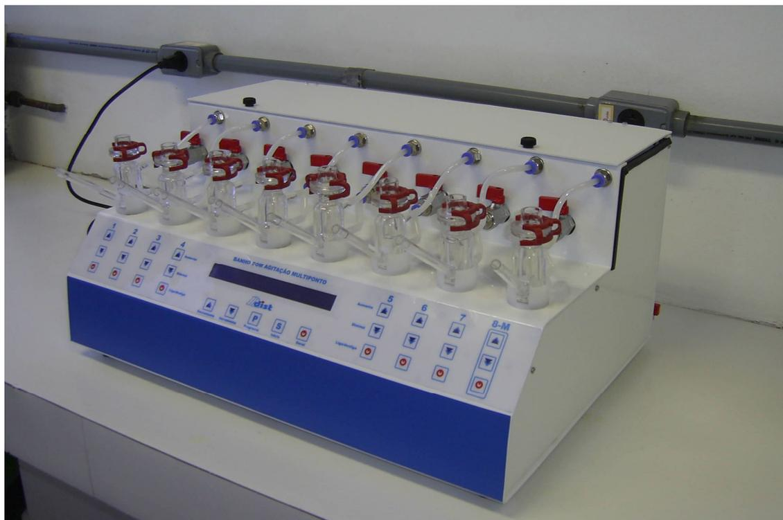
**Figura 2:** Banho termostatzado com agitação multiponto para estudos de permeabilidade *ex vivo*.
