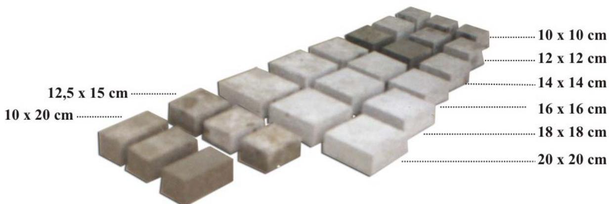
Figura 6.12 – Detalhe dos blocos de concreto serrados para ensaio de punção dupla
