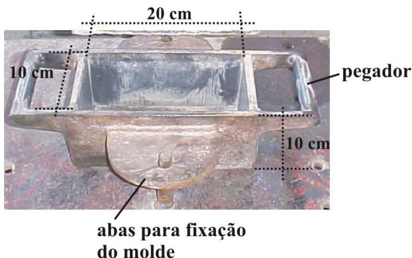
Figura 6.55 – Detalhe do molde empregado para a confecção das PCP na máquina protótipo
