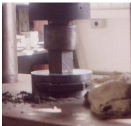
b) detalhe do ensaio de compressão
