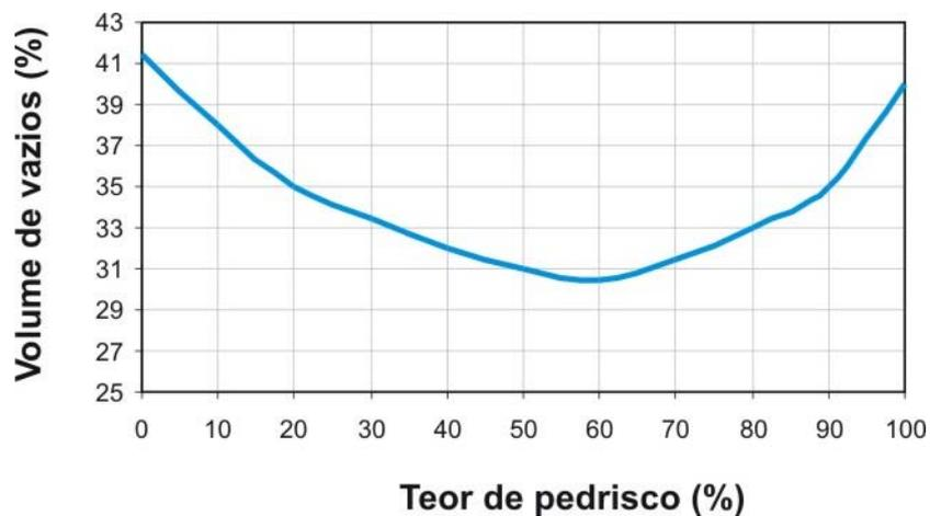
Figura 5.4 – Proporcionamento pedrisco-areia para obtenção do menor volume de vazios
