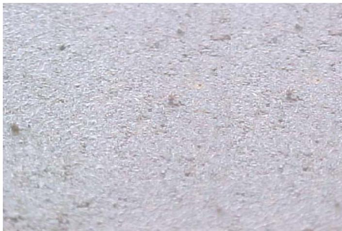
Figura 4.19 – Detalhe da superfície de uma peça produzida em um equipamento de vibro-compressão MONTANA – MBX975 com um teor de umidade ótimo ( $H \approx 7,0\%$ )
