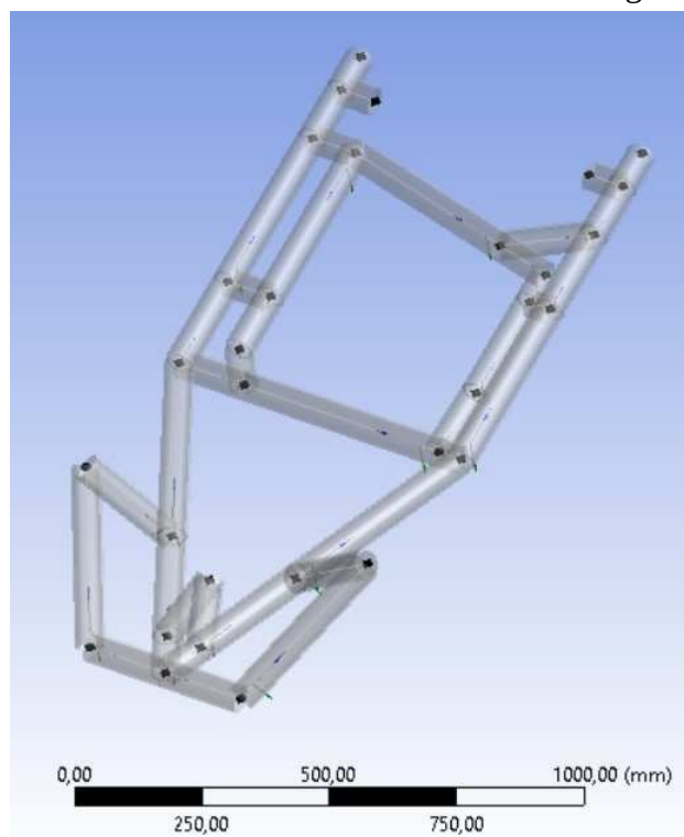
Figura 4 – Modelo de elementos de linha no DesignModeler
