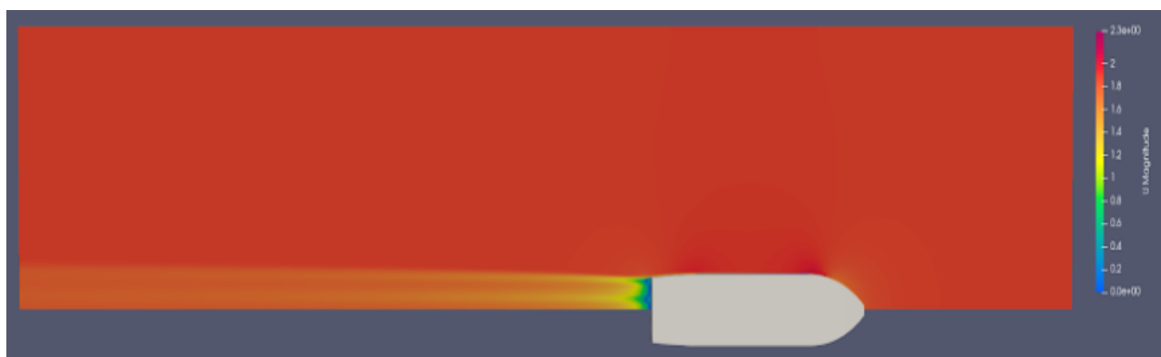
Figura 17 - Pós-processamento do campo de velocidades
