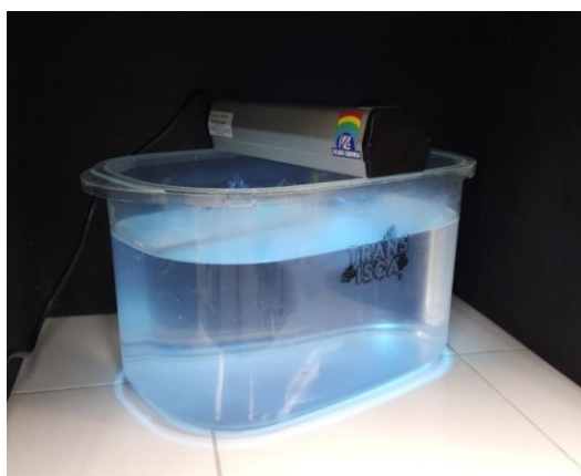
Figura 6. Aquário de irradiação equipado com lâmpada UVB, utilizado para ensaios laboratoriais de irradiação de fêmeas ovígeras e larvas de Macrobrachium olfersii .
