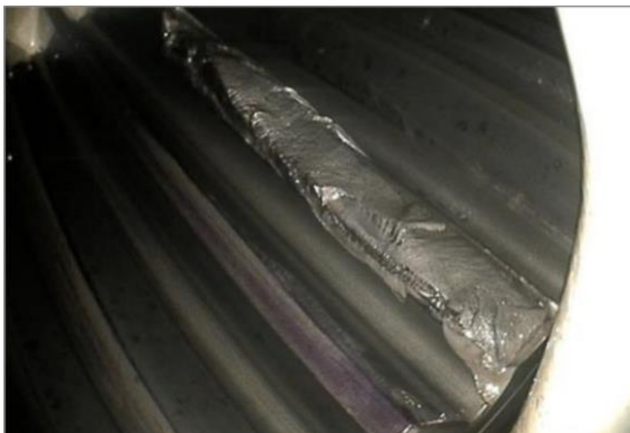
Figura 27: Dente fraturado por falha de fabricação
