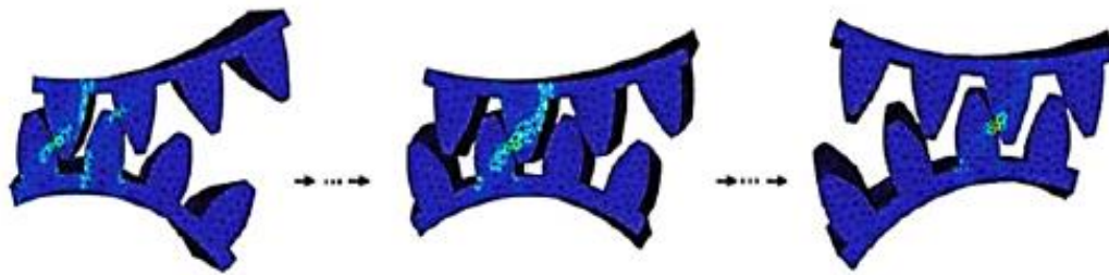
Figura 5: Tensões na superfície da engrenagem
