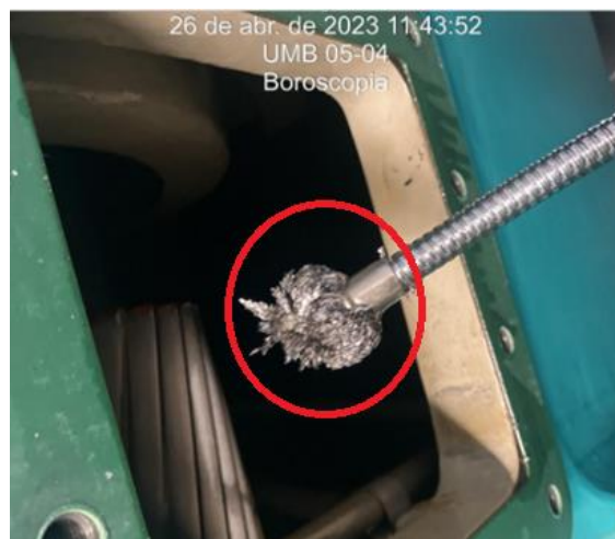
Figura 18: Teste com imã inserido no óleo antes da boroscopia
