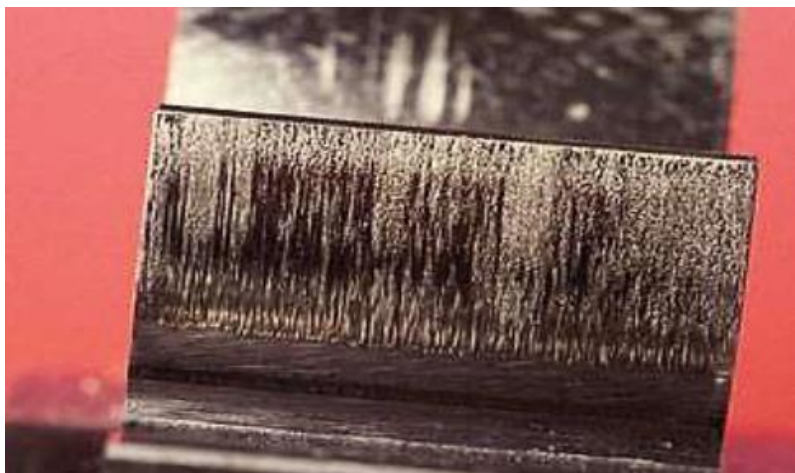
Figura 14: Danos causados por scuffing na superfície do dente
