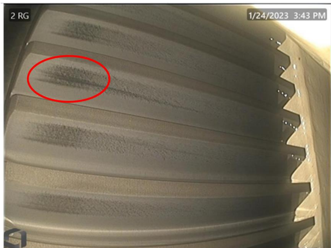
Figura 20: Engrenagem com características de Micropitting
