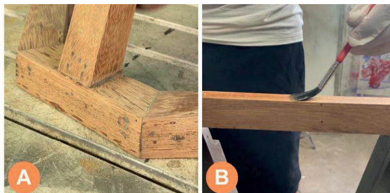
Figura 3: Processamento das madeiras: (A) união com cola branca e pinos de aço e (B) envernizamento das partes. Fonte: autores (2025).
