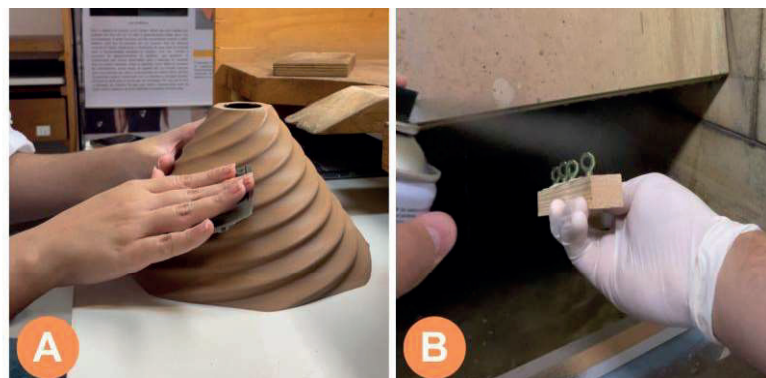
Figura 7: Acabamento superficial das peças: (A) lixamento da cúpula e (B) aplicação de primer nas peças complementares. Fonte: autores (2025).
