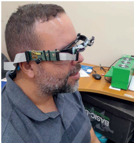
Figura 7: Sessão de teste para avaliar a funcionalidade do dispositivo sensorial. Fonte: Os autores
