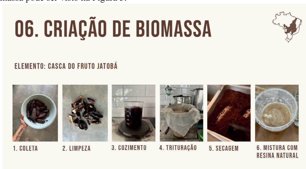
Figura 5: Processo de produção da biomassa de jatobá. Fonte: Os autores, 2024.
